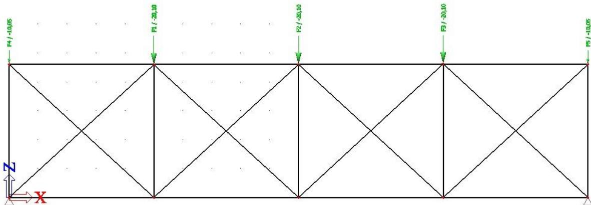
Slika 20. Prikaz sekundarnih nosača sa djelujućim silama
