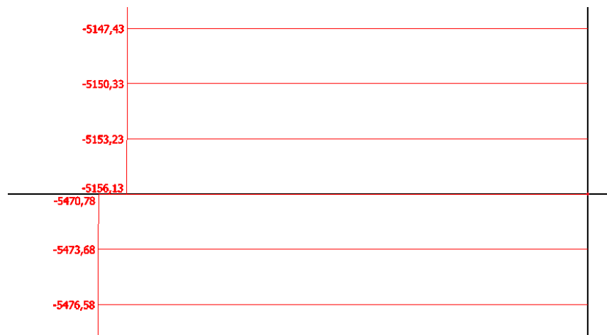
Slika 7.15 Dijagram uzdužnih sila stupa na spoju s gredom na etaži 1 (kN)
