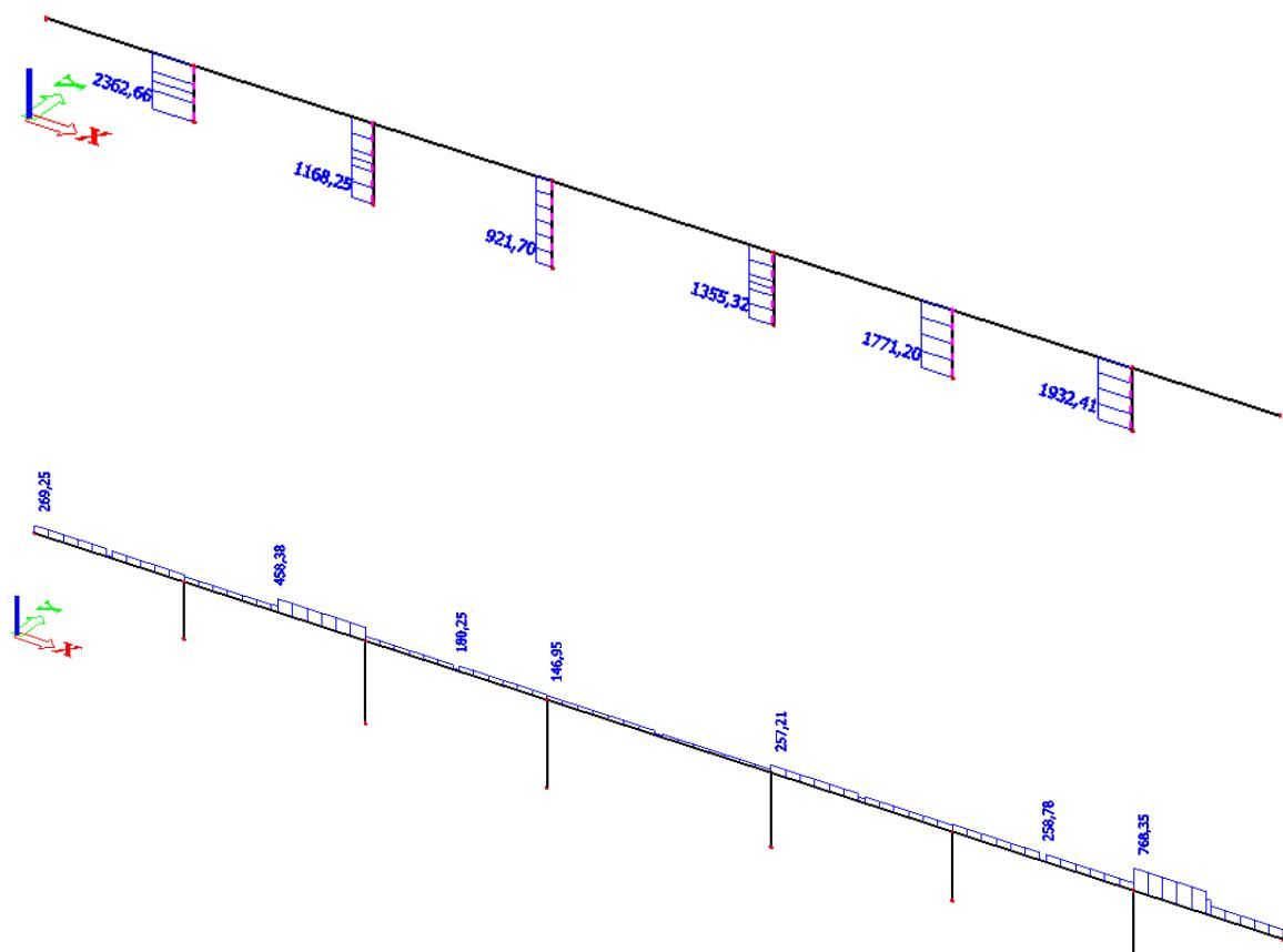
Slika 1.77. - Poprečna sila  $V_v$  ( $S_x$ )
