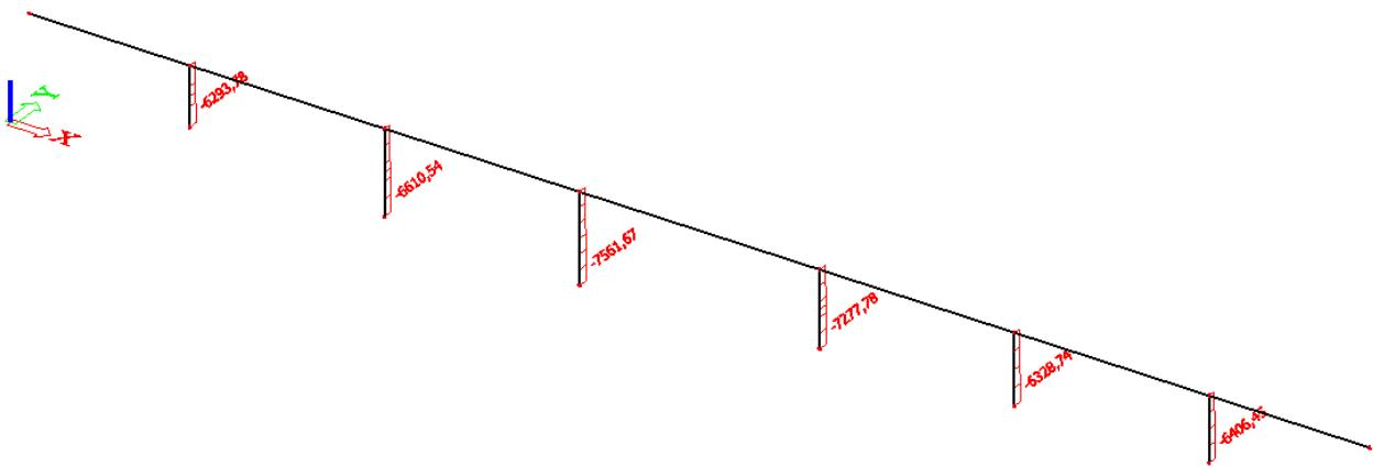
Slika 1.78. – Uzdužna sila od stalnog opterećenja
