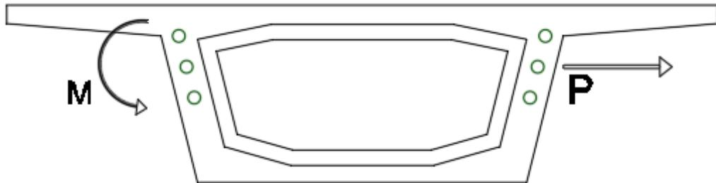
Slika 1.26. - Presjek nosača iznad nosača s prikazom djelovanja
