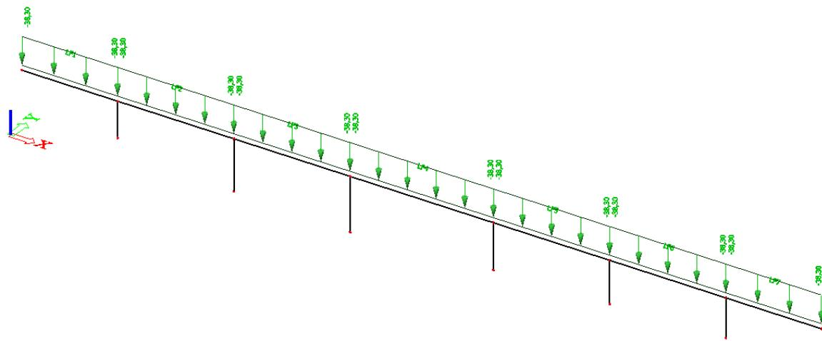
Slika 1.9. – Prikaz opterećenja (dodatno stalno opterećenje)
