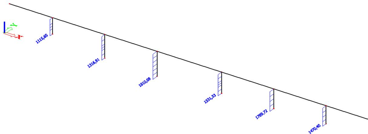
Slika 1.75. - Poprečna sila  $V_y$  ( $S_y$ )
