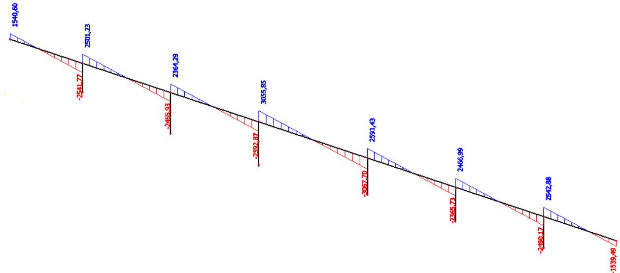
Slika 1.8. - Poprečna sila  $V_z$  (vlastita težina)
