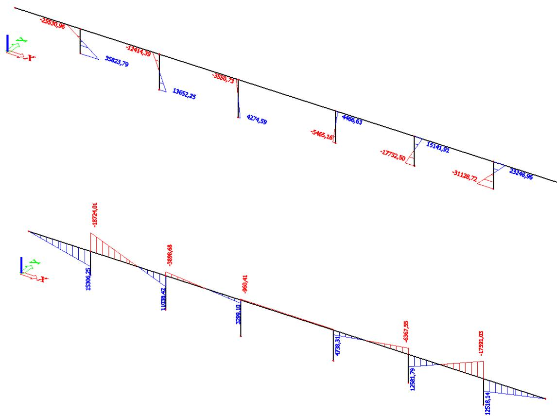
Slika 1.63. -Moment savijanja  $M_y$  (jednolika temperatura)
