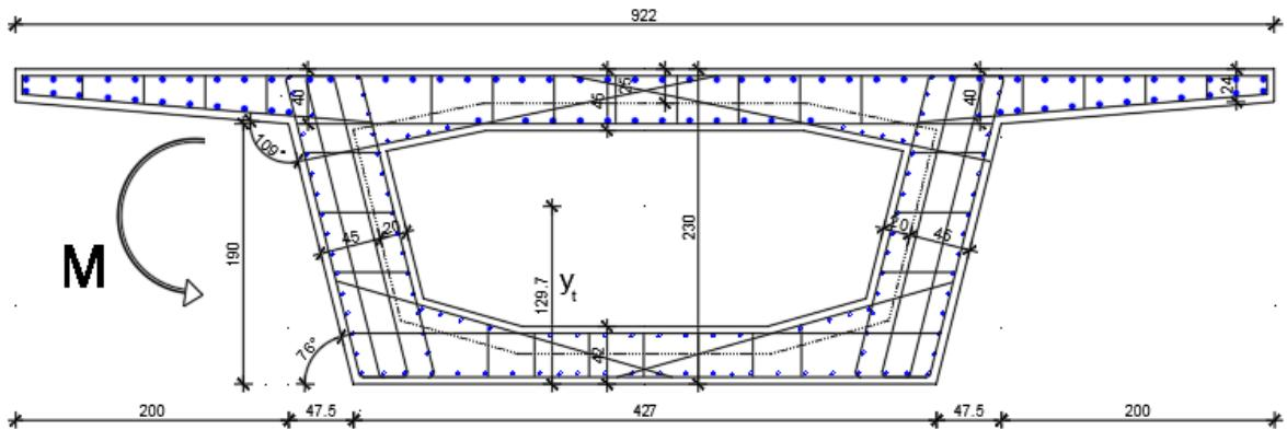
Slika 1.40. - Presjek nosača iznad ležaja s prikazom djelovanja
