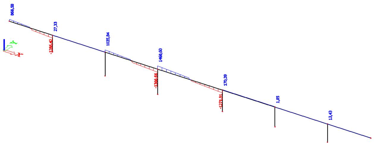
Slika 1.20. -Poprečna sila  $V_z$  (prometno opterećenje-maksimalna uzdužna sila u najvišem stupu)
