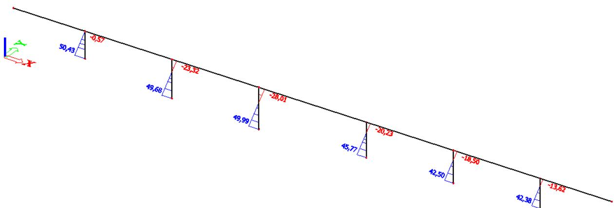
Slika 1.55. - Poprečna sila  $V_z$  (vjetar uzdužno na puni most)
