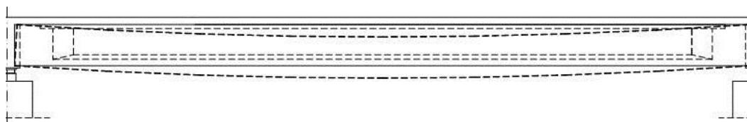
Slika 1.27. – Prikaz oblika nosača nakon opterećivanja
