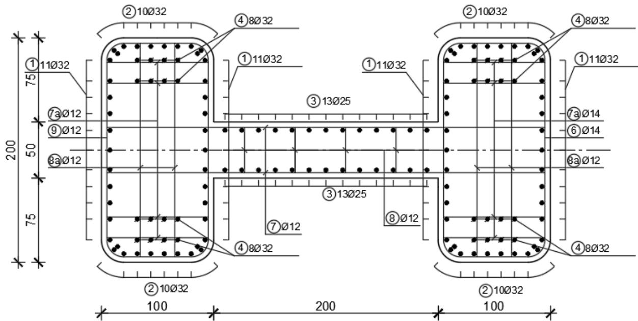
Slika 1.95. - Poprečni presjek stupa S1 sa prikazom armature
