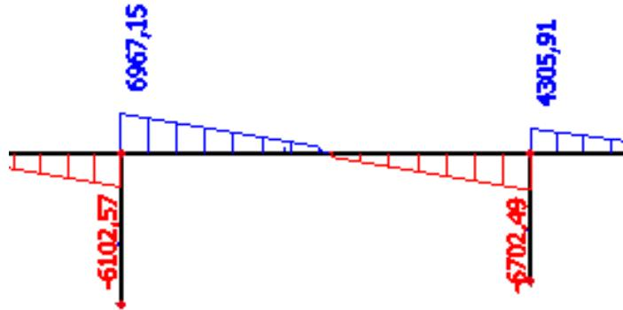
Slika 1.41. – Prikaz mjerodavne poprečne sile (unutarnji nosači)
