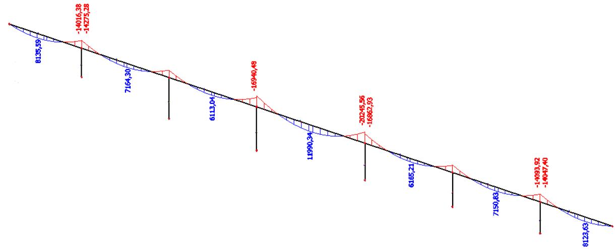
Slika 1.7. - Moment  $M_y$  (vlastita težina)
