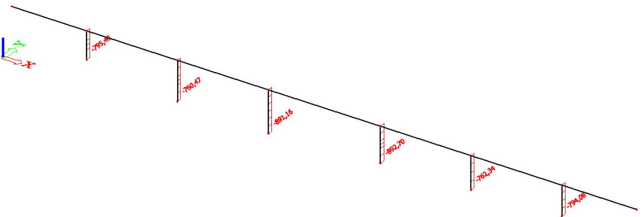
Slika 1.79. – Uzdužna sila od dodatnog stalnog opterećenja
