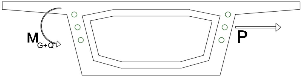
Slika 1.29. - Presjek nosača iznad ležaja s prikazom djelovanja
