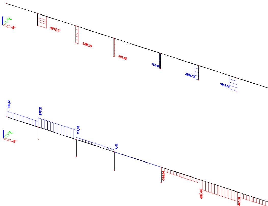
Slika 1.64. - Poprečna sila  $V_z$  (jednolika temperatura)
