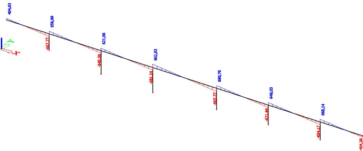
Slika 1.11. -Poprečna sila  $V_z$  (dodatno stalno opterećenje)
