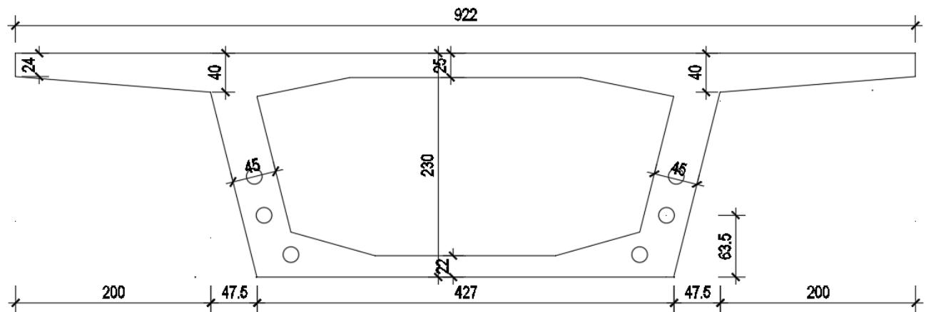
Slika 1.22. - Presjek nosača u polju s položajem kablova
