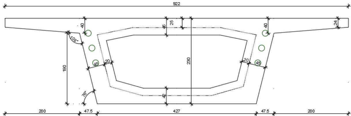
Slika 1.23. - Presjek nosača u polju s položajem kablova
