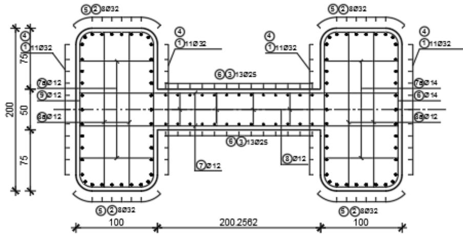
Slika 1.82. - Poprečni presjek stupa S3 s prikazom armature
