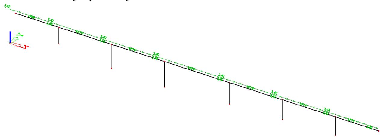
Slika 1.65. – Prikaz opterećenja (sile kočenja i pokretanja vozila)
