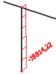
Slika 1.86. – dijagram uzdužnih sila
