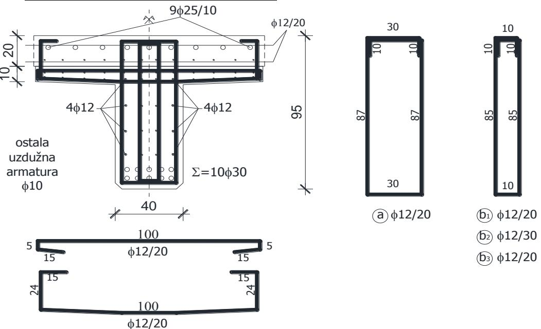
Slika 33 : Prikaz armiranja nosača u presjeku a-a
