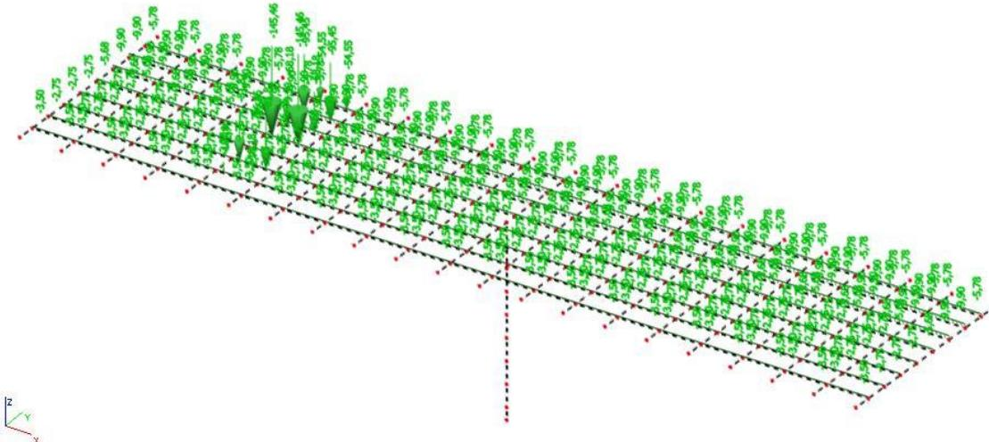
Slika 18 : Pokretno opterećenje za max. moment pri stupu
