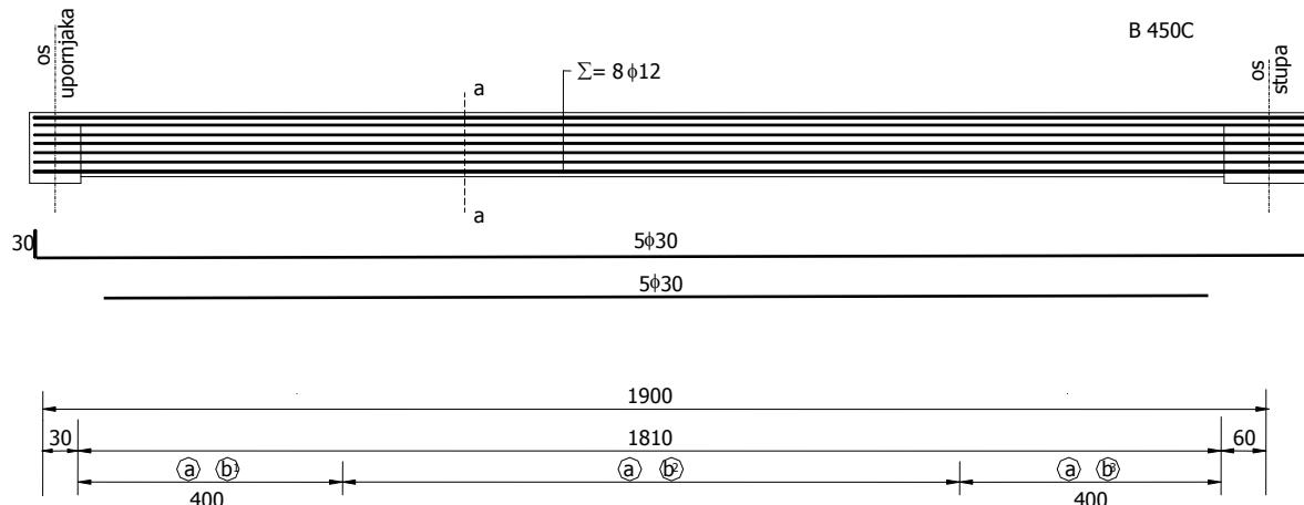
Slika 32 : Prikaz armiranja uzdužnog nosača u polju
