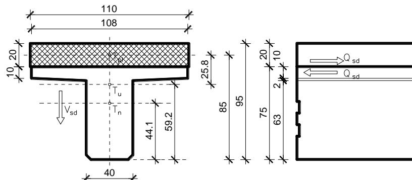
Slika 31 : Poprečni presjek spregnutog T nosača
