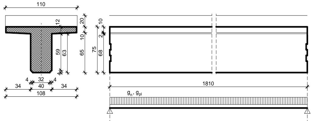
Slika 2 : Uzdužna i poprečna dispozicija jednog nosača
