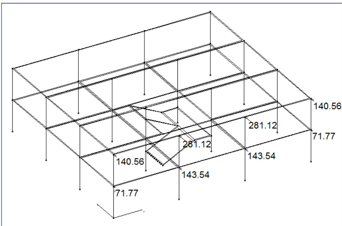
Slika 2.17. Potresno opterećenje Y smjer (sile u kN)
