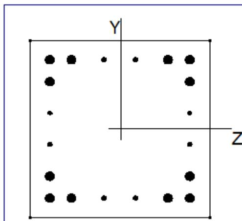
Slika 8.17. Poprečni presjek stupa s armaturom (AspalathosSectionDesign)
