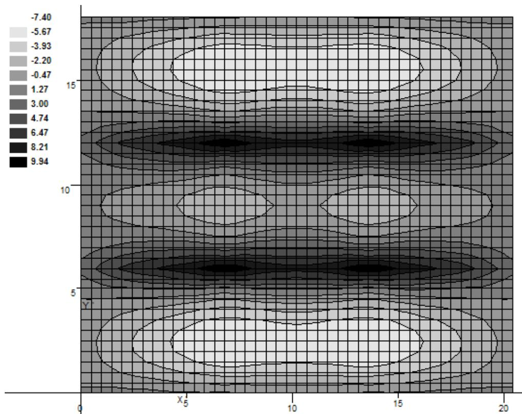
Slika 3.9. Količina potrebne armature  $M_y$  ( $\text{cm}^2/\text{m}'$ )
