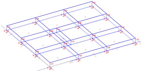
Slika 2.3. Prikaz dodatnog stalnog opterećenja  $G_0$
