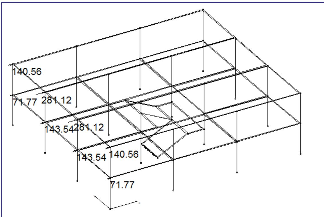
Slika 2.16. Potresno opterećenje X smjer (sile u kN)
