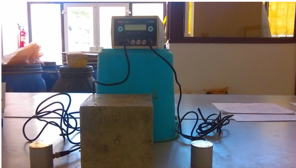
Slika 4.20. Ispitivanje ultrazvukom [slika zabilježena tijekom ispitivanja]
