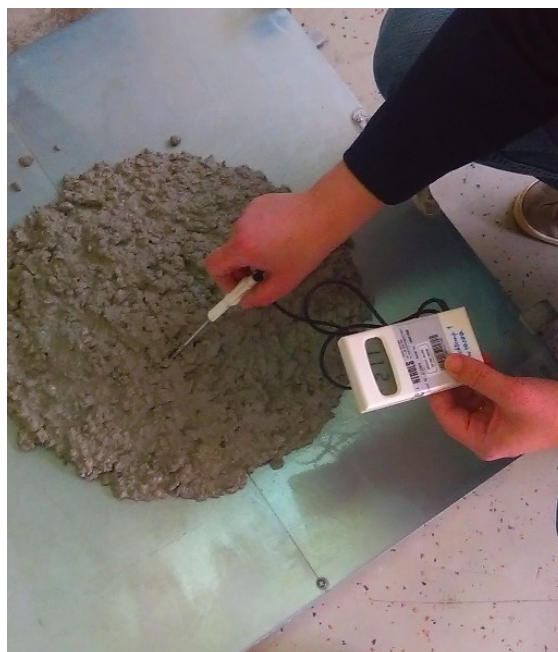
Slika 4.16. Mjerenje temperature [slika zabilježena tijekom ispitivanja]
