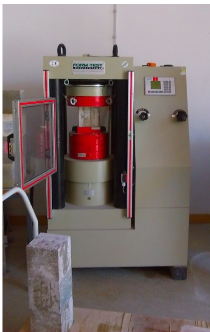
Slika 4.18. Laboratorijska preša za određivanje tlačne čvrstoće betonskih uzoraka [slika zabilježena tijekom ispitivanja]
