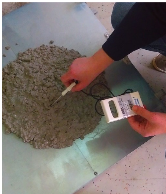
Slika 4.16. Mjerenje temperature [slika zabilježena tijekom ispitivanja]
