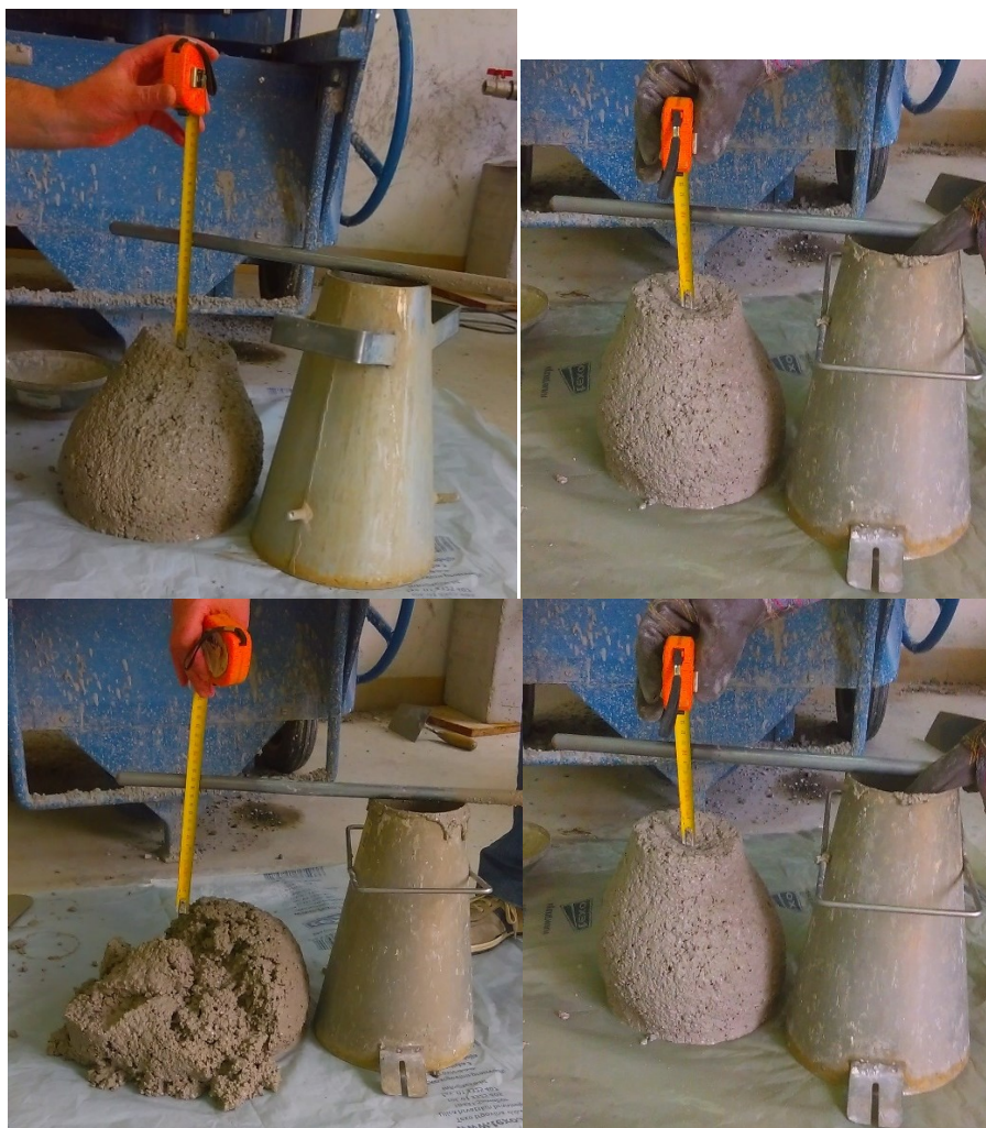
Slika 4.7. Slijeganja uzoraka betona [slika zabilježena tijekom ispitivanja]
