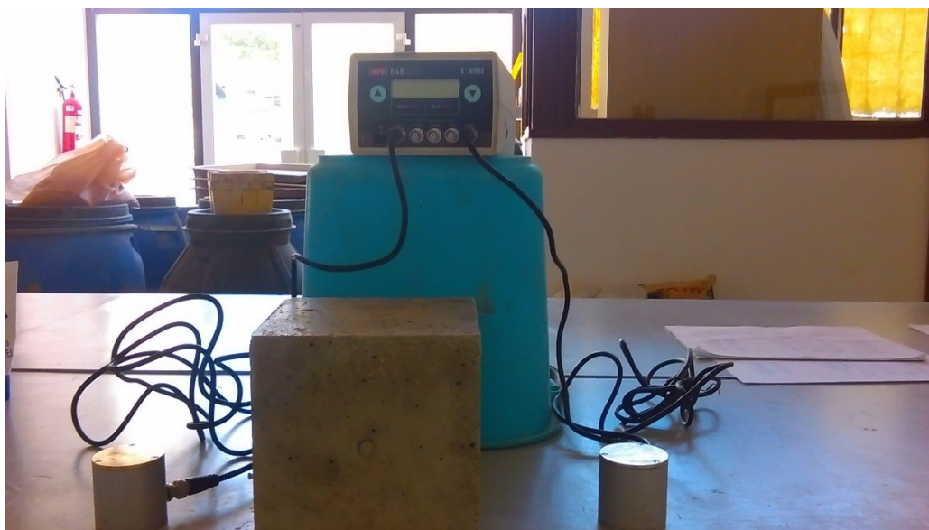
Slika 4.20. Ispitivanje ultrazvukom [slika zabilježena tijekom ispitivanja]
