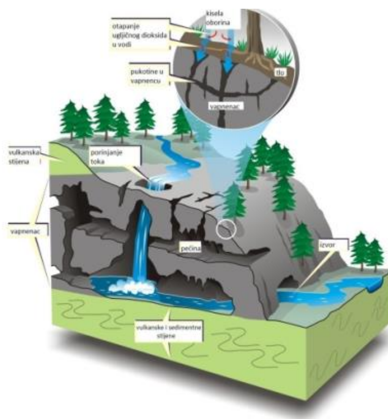
Slika 2.5 Prikaz sustava otjecanja vode u kršu
