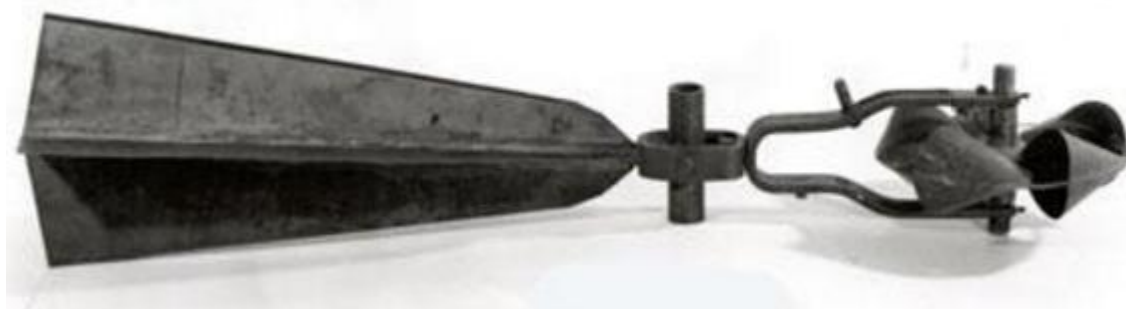
Slika 3.3 Originalno AA hidrometrijsko krilo W.G.Pricea, 1880. godina [14]
