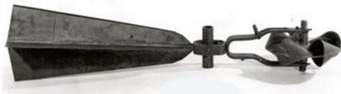
Slika 3.3 Originalno AA hidrometrijsko krilo W.G.Pricea, 1880. godina [14]
