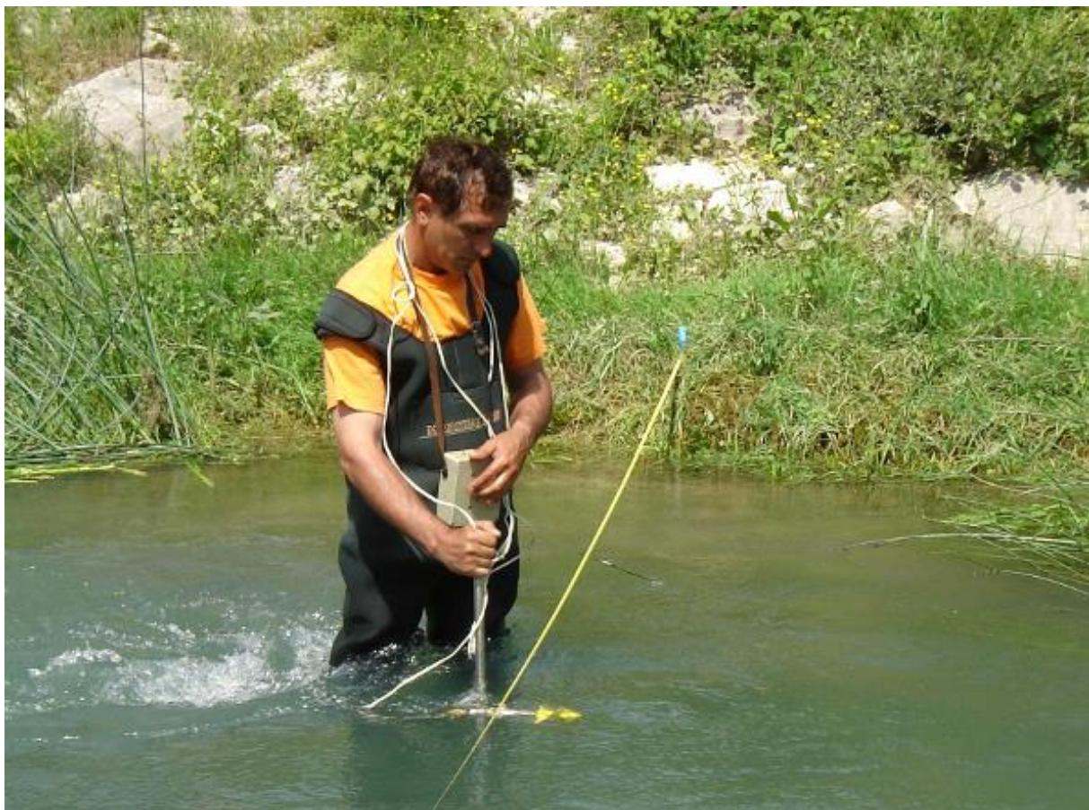
Slika 3.4 Mjerjenje brzine strujanja vode hidrometrijskim krilom [14]
