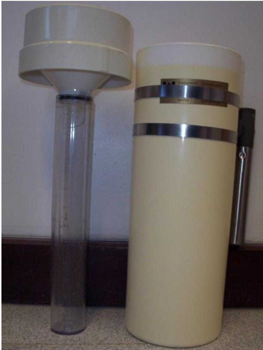
Slika 3.2 Standardni kišomjer [12]
