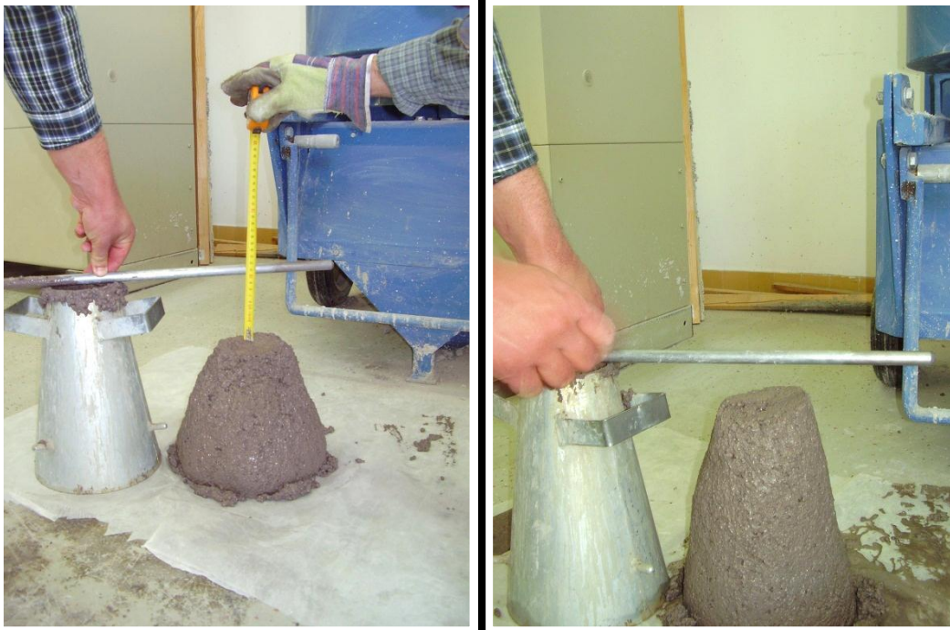
Slika 4.2. Slijeganje mješavine LBI [slike zabilježene tijekom ispitivanja]: a) neposredno nakon miješanja, b) 30 minuta nakon miješanja
