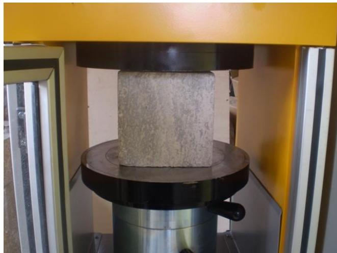
**Slika 4.5.** Uredaj za ispitivanje tlačne čvrstoće betona [10]
