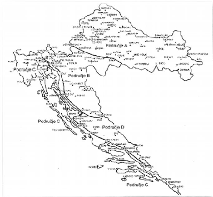
$s_k = 1,0 \text{ kN/m}^2$  - očitano za Osijek (područje A do 100 m n.m.)
