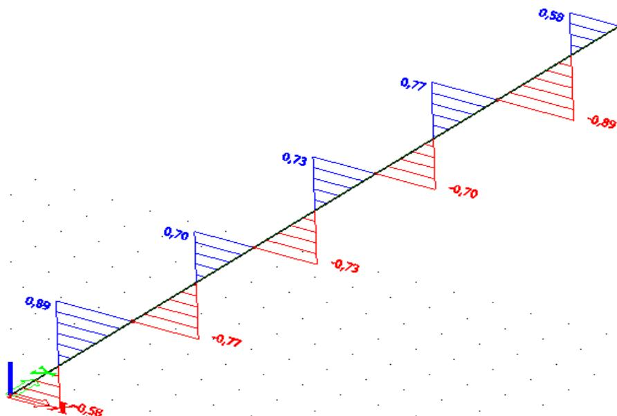
Slika 4.2.1.1.4. Dijagram poprečnih sila u y smjeru kombinacije 1
