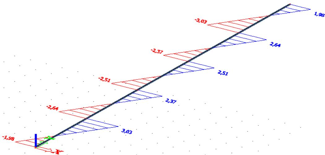
Slika 4.2.2.2.2. Dijagram poprečnih sila u z smjeru kombinacije 2
