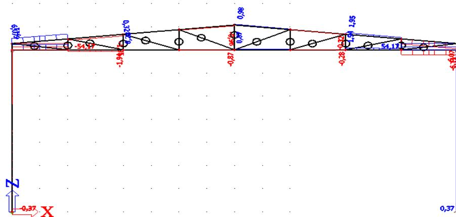
Slika 4.1.1.2. Dijagram poprečnih sil opterećenja kombinacije 1
