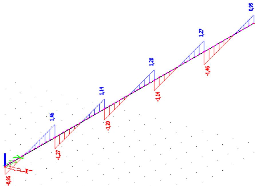
Slika 4.2.1.2.2. Dijagram poprečnih sila u z smjeru kombinacije 2
