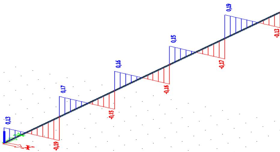
Slika 4.2.2.2.4. Dijagram poprečnih sila u z smjeru kombinacije 2
