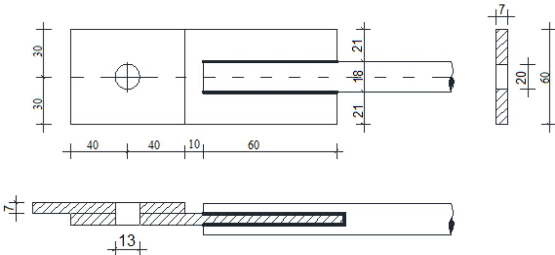
Slika 6.9.1. Detalj spoja bočnih i krovnih spregova
