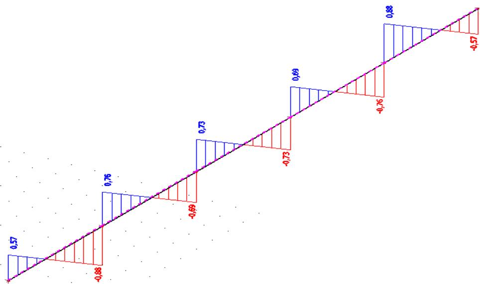
Slika 4.2.2.1.3. Dijagram poprečnih sila u y smjeru kombinacije 1
