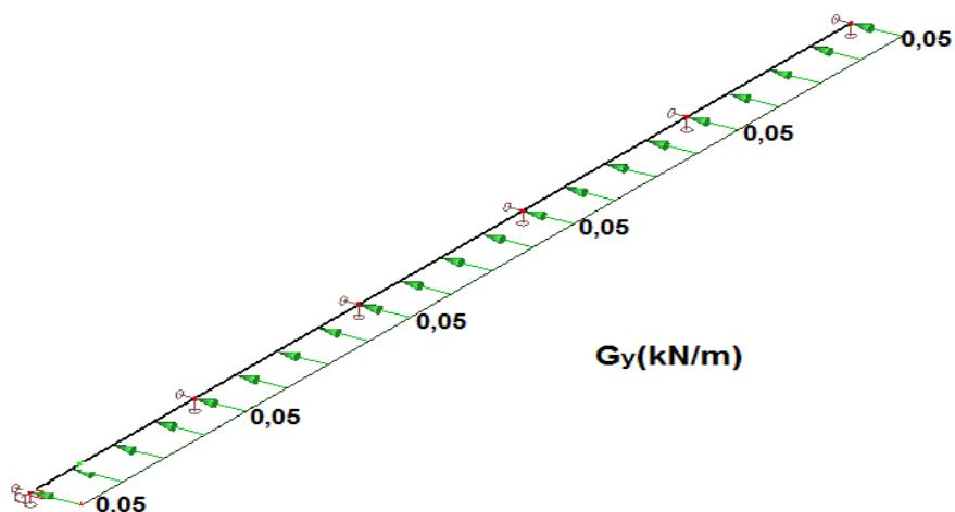
Slika 2.2.1.1.2. Opterećenje sendvič panelima u y smjeru
