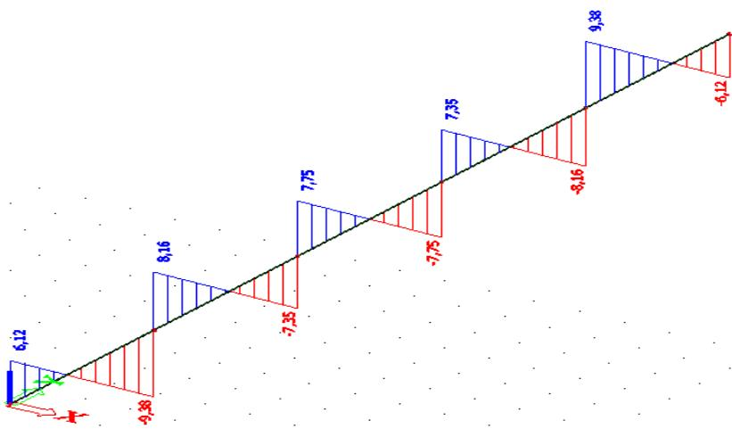
Slika 4.2.1.1.2. Dijagram poprečnih sila u z smjeru kombinacije 1
