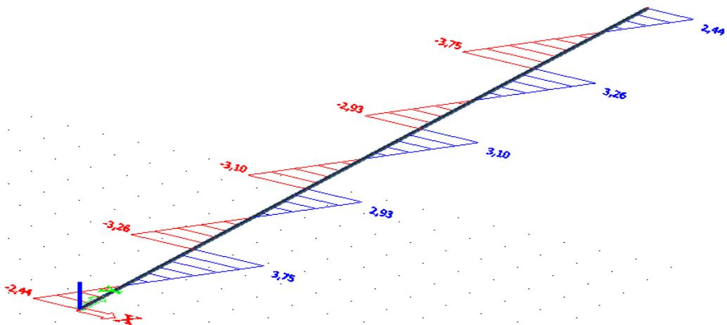
Slika 4.2.2.1.2. Dijagram poprečnih sila u z smjeru kombinacije 1
