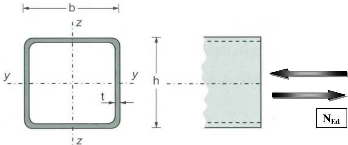
Slika 5.1.3.1 Poprečni presjek ispuna (vertikale i dijagonale)
