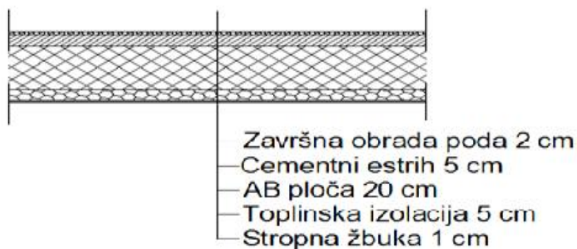
Slika 10: Presjek poda između garaže i prizemlja
