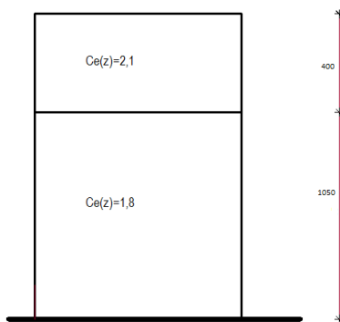
Slika 19: Koeficijent izloženosti c_e(z) u ovisnosti o kategoriji terena I do IV i visini z iznad terena
