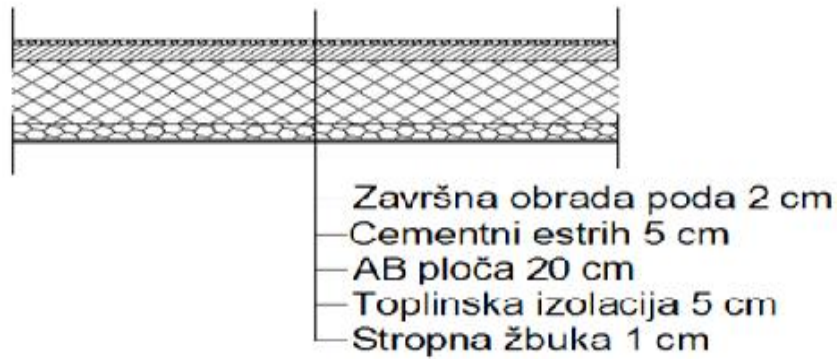
Slika 10: Presjek poda između garaže i prizemlja
