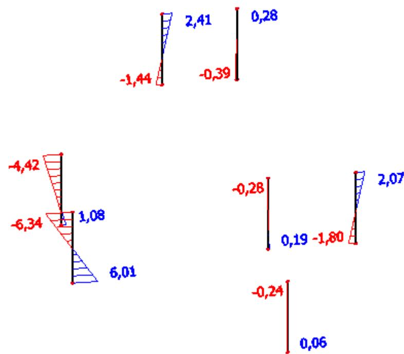
**Slika 7.23:** Momenți savijanja  $MS_d,y [kNm]$  na stupovima za potresnu kombinaciju  $GSN-1,0G+1,0Q+1,0Sx+0,3Sy$
