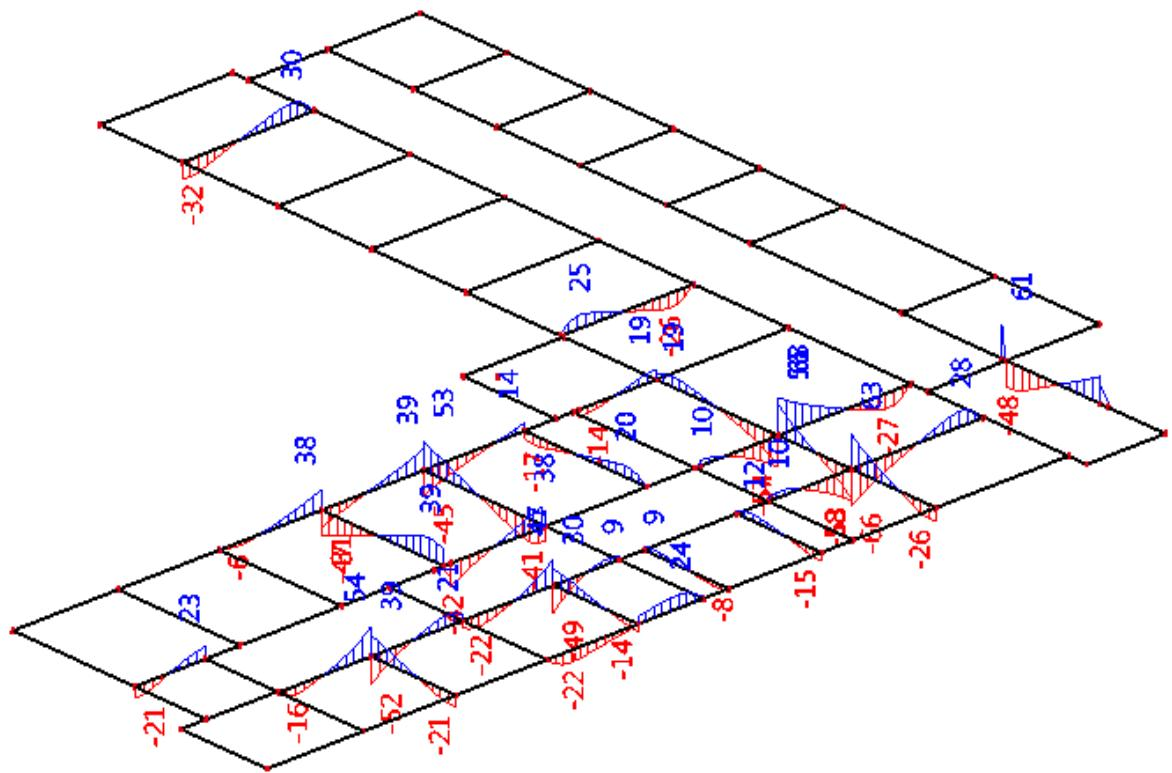
**Slika 7.17:** Poprečne sile VSd,z [kN] na gredama za osnovnu kombinaciju
