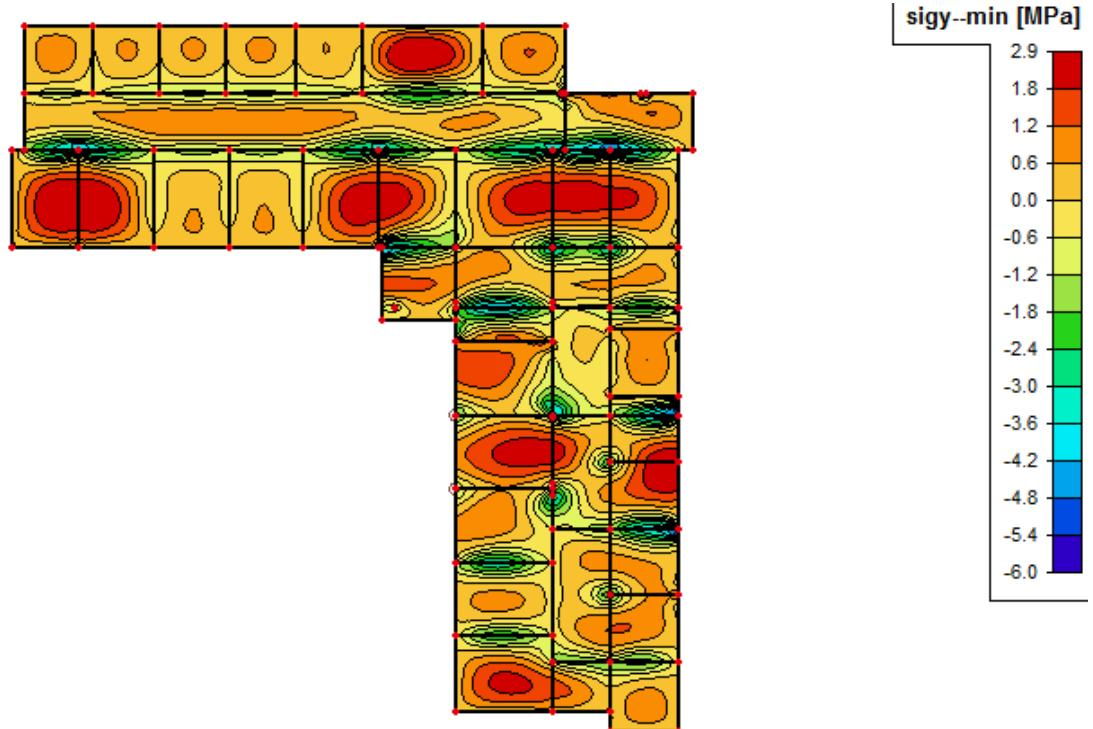
Slika 7.13: Tlačna naprezanja u betonu na donjoj plohi ploče  $\sigma_{cy,+}$  [MPa] u smjeru Y za osnovnu kombinaciju (1,35G + 0,6Q)
