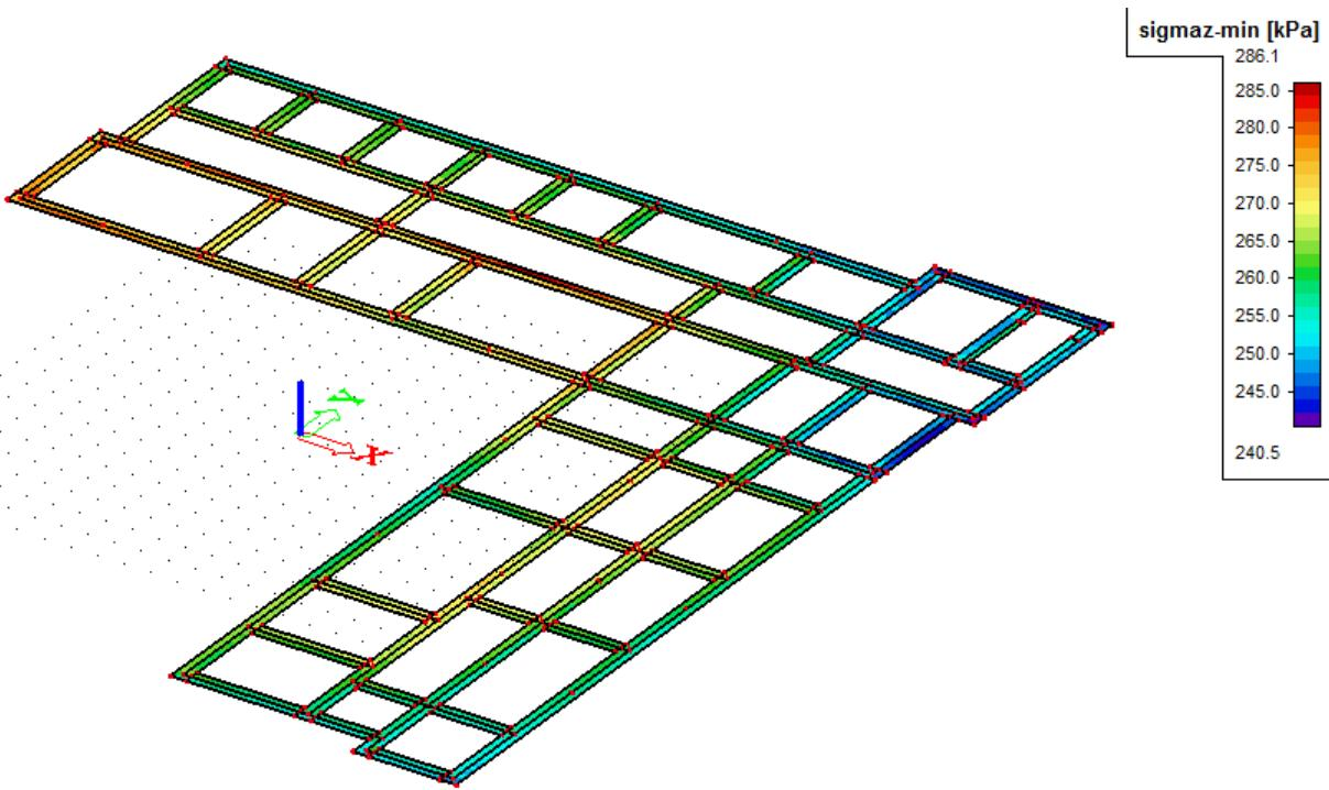
Slika 7.32: Naprezanja [kPa] na kontaktu temeljnih traka/tlo za kombinaciju GSN:
