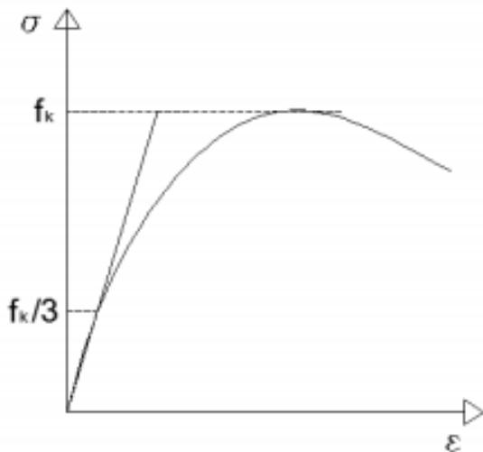
Slika 1.15: Dijagram naprezanja-relativna deformacija
