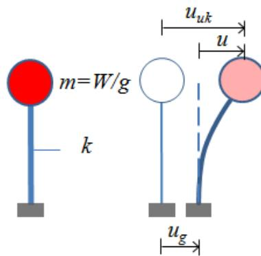
Slika 6.2: Jednostupnjevni model – jednostupnjevni sustav
