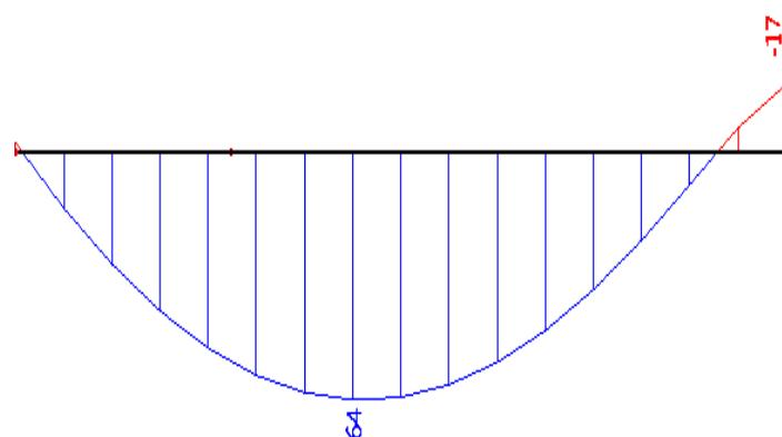
*Slika 7.16:* Mjerodavni momenti savijanja  $MS_{d,y}$  [kNm] na gredama za osnovnu kombinaciju
