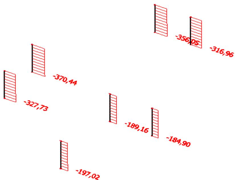
Slika 7.24: Uzdužne sile  $NS_d$  [kN] na stupovima za potresnu kombinaciju GSN-1,35G+1,5Q
