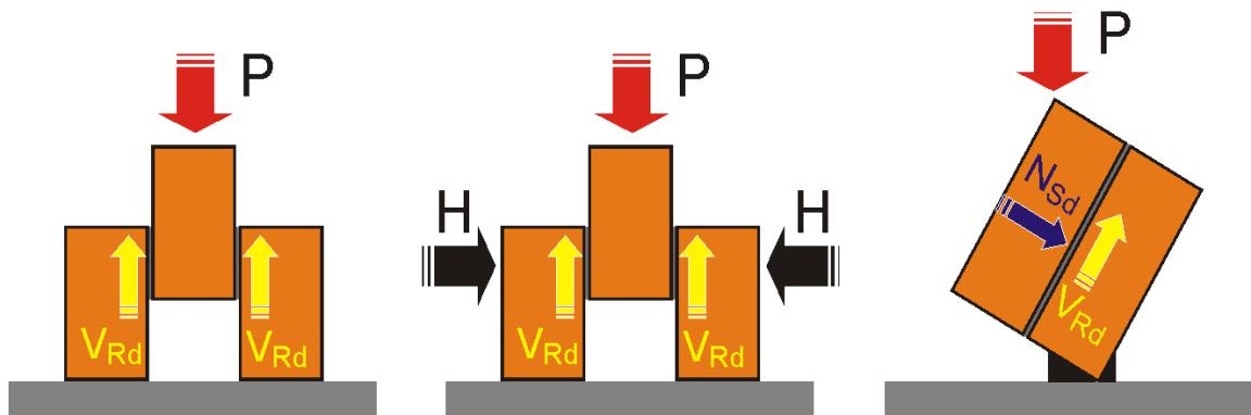
Slika 1.10: Ispitivanje posmične čvrstoće ziđa
