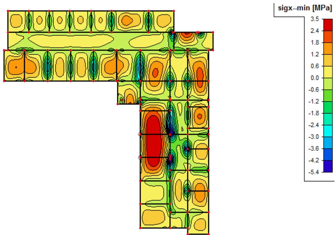
Slika 7.12: Tlačna naprezanja u betonu na donjoj plohi ploče  $\sigma_{cx,+}$  [MPa] u smjeru X za osnovnu kombinaciju (1,35G + 1,5Q)
