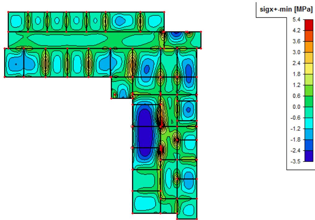
Slika 7.10: Tlačna naprezanja u betonu na gornjoj plohi ploče  $\sigma_{c,x,+}$  [MPa] u smjeru X za osnovnu kombinaciju  $(1,35G + 1,5Q)$
