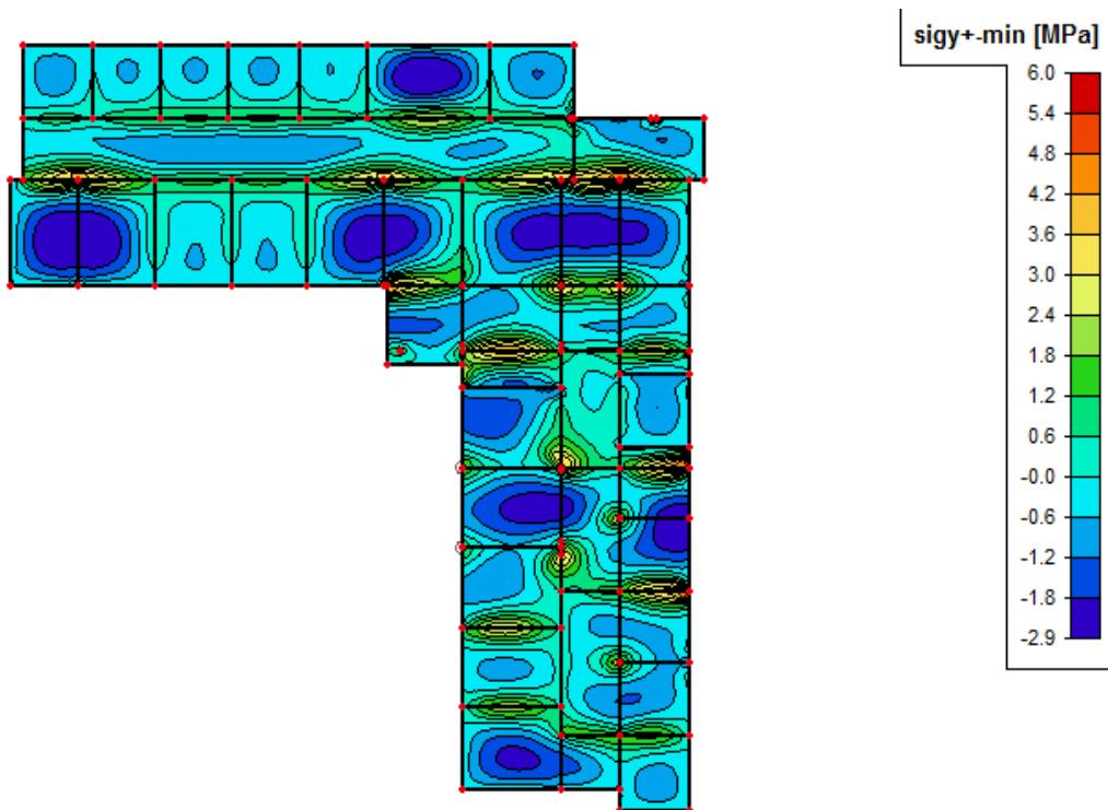
Slika 7.11: Tlačna naprezanja u betonu na gornjoj plohi ploče  $\sigma_{c,y,+}$  [MPa] u smjeru Y za osnovnu kombinaciju  $(1,35G + 1,5Q)$
