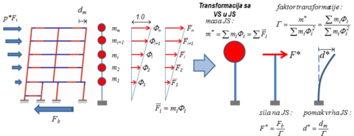
Slika 6.7: Shematisirani prikaz transformacije višestupnjevnog sustava u ekvivalentni jednostupnjevni
