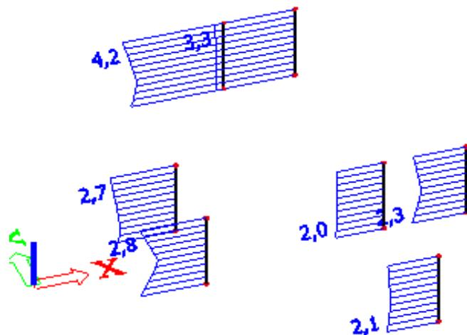
*Slika 7.19: Naprezanja u stupovima  $\sigma_{c,\max}$  [MPa] za kombinaciju GSU-2: 1,0G + 0,5QI*
