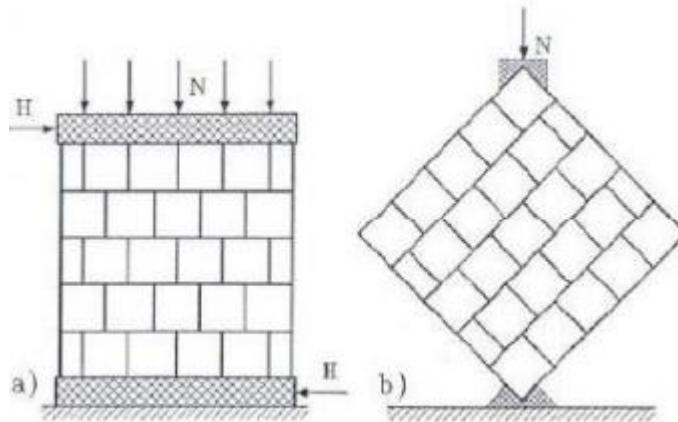
Slika 1.12: Ispitivanje vlačne čvrstoće zida
