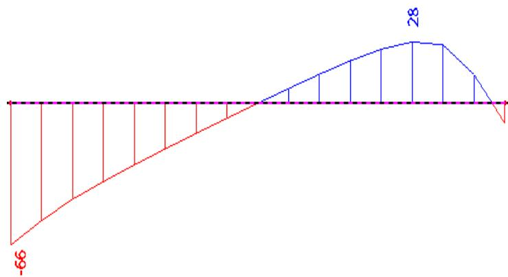
**Slika 7.18:** Mjerodavna poprečna sila  $VSd,z$  [kN] na gredama za osnovnu kombinaciju
