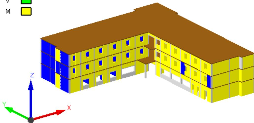
Slika 6.20: O Oštećenje konstrukcije pri opterećenju od ukupne slomne poprečne sile u Y smjeru
