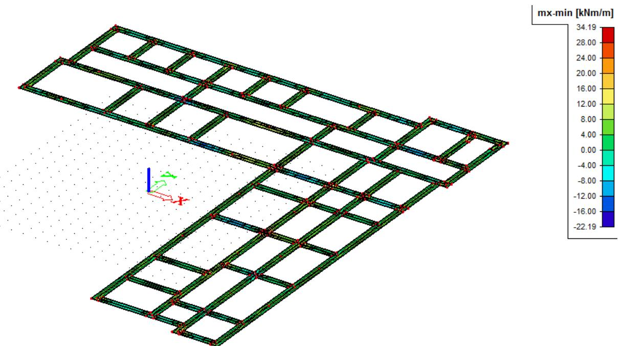
Slika 7.30: Moment savijanja  $MS_{d,x}$  [kNm/m], za kombinaciju GSN-1: 1,35G+1,5Q1
