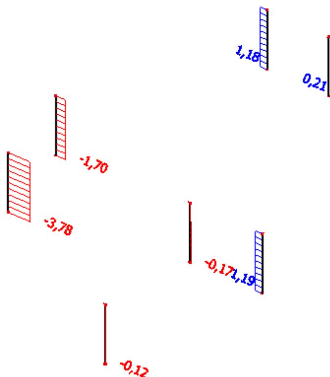
Slika 7.25: Poprečne sile  $VS_{d,z}$  [kN] na stupovima za potresnu kombinaciju GSN-1,35G+1,5Q
