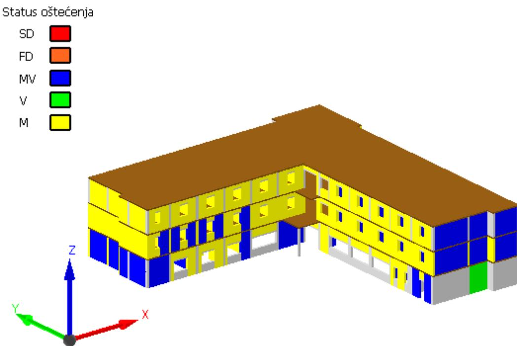
Slika 6.17: Oštećenje konstrukcije pri opterećenju od ukupne slomne poprečne sile u X smjeru
