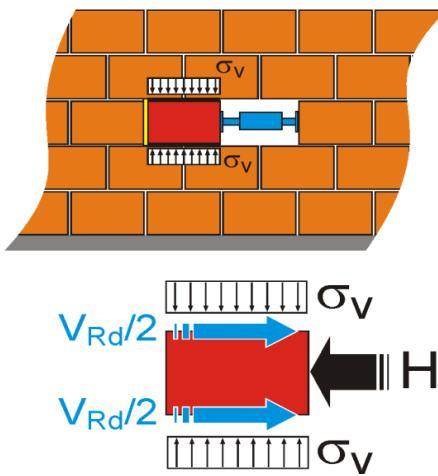
Slika 1.11: Ispitivanje posmične čvrstoće ziđa – in situ
