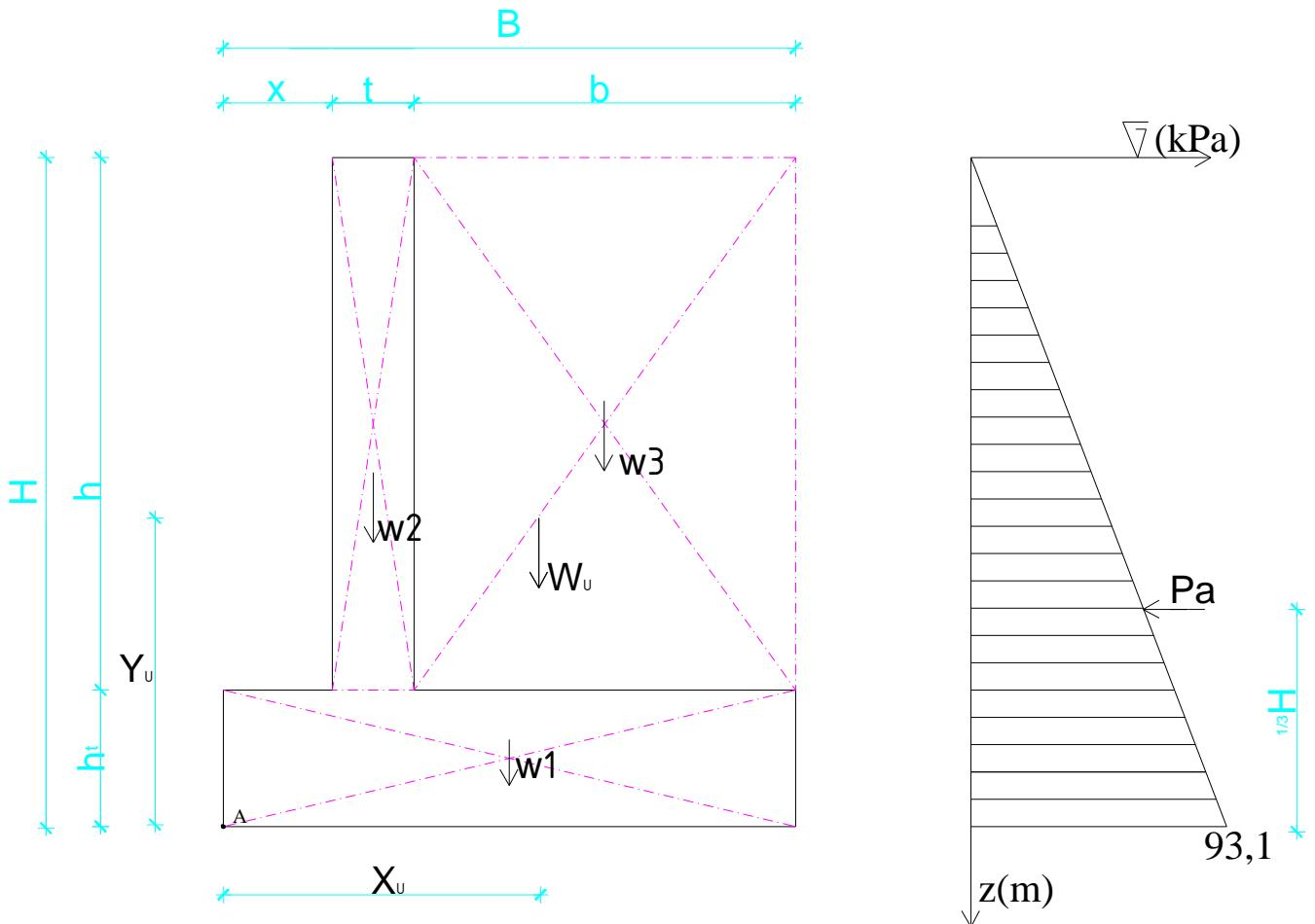
Za proračun stabilnosti na klizanje i nosivosti tla ispod temelja (GEO,STR) korišten je proračunski pristup 3, a za prevrtanje (EQU) parcijalni faktori navedni u prilogu 1.
