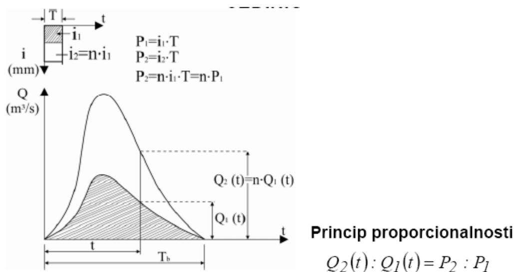
Slika 3.2.2. Princip proporcionalnosti
