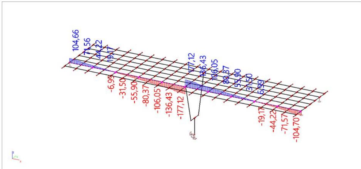
Slika 12 : Stalno – poprečne sile (  $V_z$  ) u Kn
