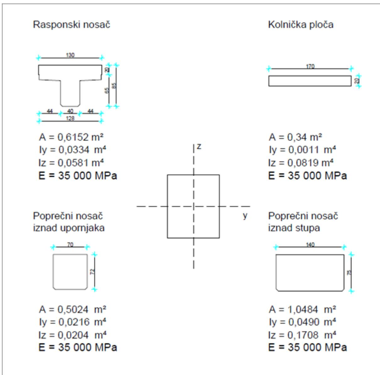
Slika 9 : Karakteristike poprečnih presjeka gornjeg ustroja mosta
