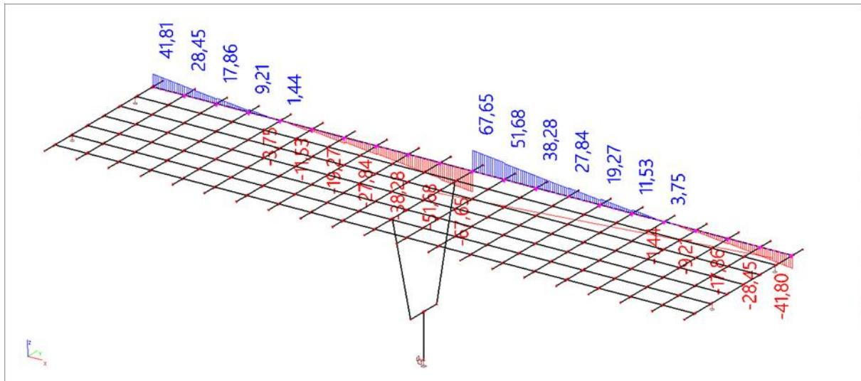
Slika 15 : Dodatno stalno – poprečne sile (  $V_z$  ) u kN
