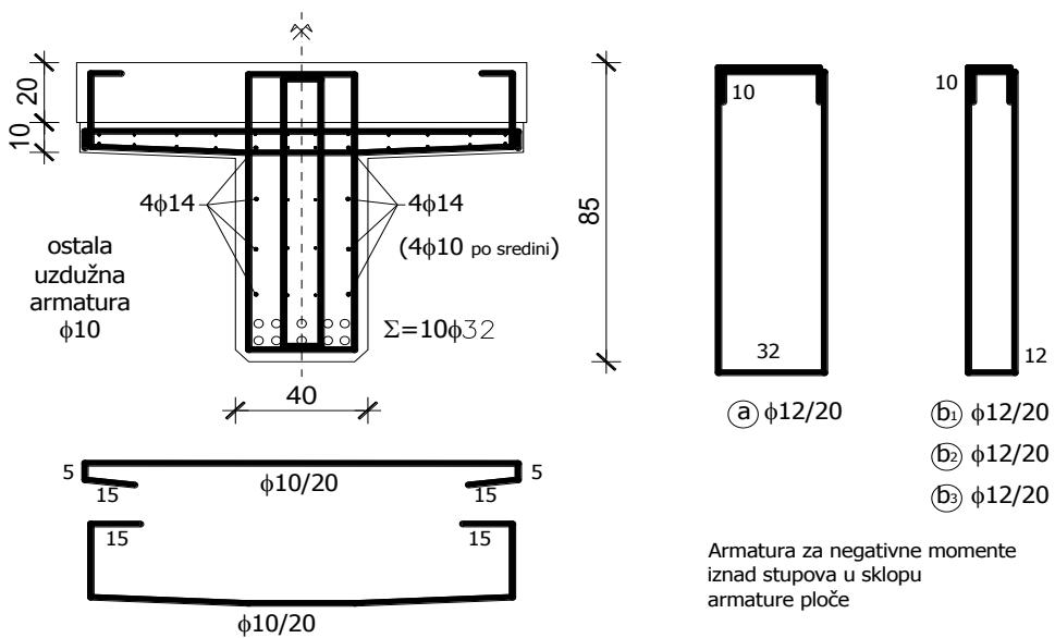
Slika 36 : Prikaz armiranja nosača u presjeku a-a
