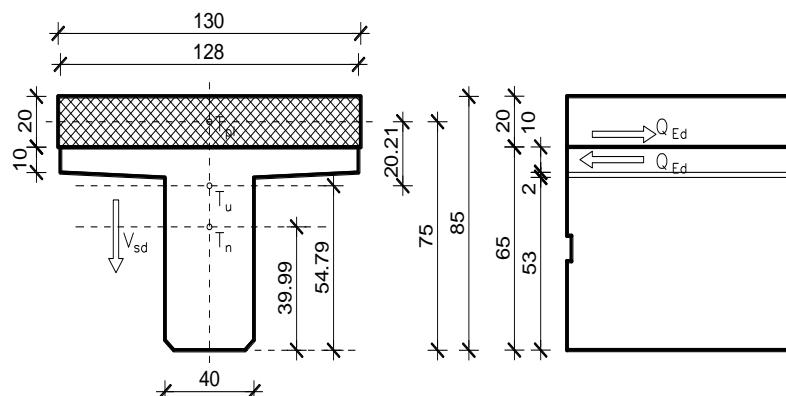
Slika 34 : Poprečni presjek spregnutog T nosača
