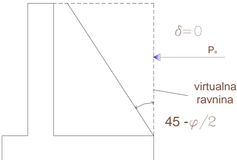
Za proračun stabilnosti na prevrtanje (EQU), na klizanje (GEO/STR) i nosivost tla (GEO/STR) korišteno je granično stanje nosivosti: EQU, GEO/STR (proračunski pristup 3) , parcijalni faktori navedeni u prilogu broj 1.
