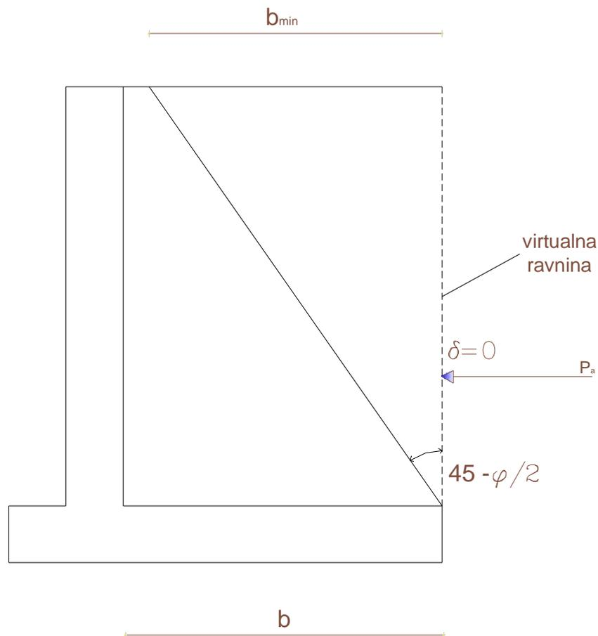
Za proračun stabilnosti na prevrtanje (EQU), na klizanje (GEO/STR) i nosivost tla (GEO/STR) korišteno je granično stanje nosivosti: EQU, GEO/STR (proračunski pristup 3), parcijalni faktori navedeni u prilogu broj 1.
