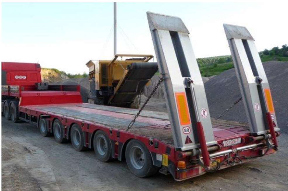
Slika 2.13 labudica od 30 tona nosivosti
