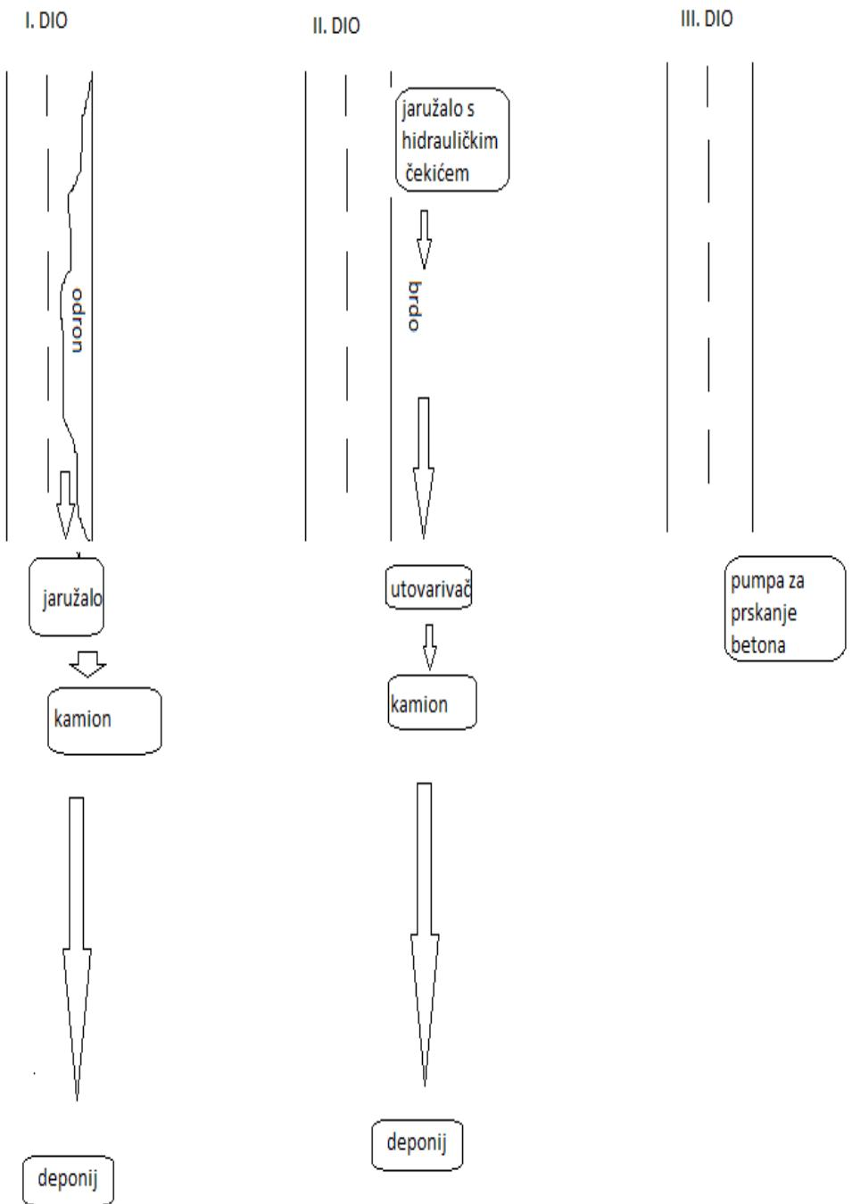
Slika 3.1 Shematski prikaz slijeda korištenja strojeva
