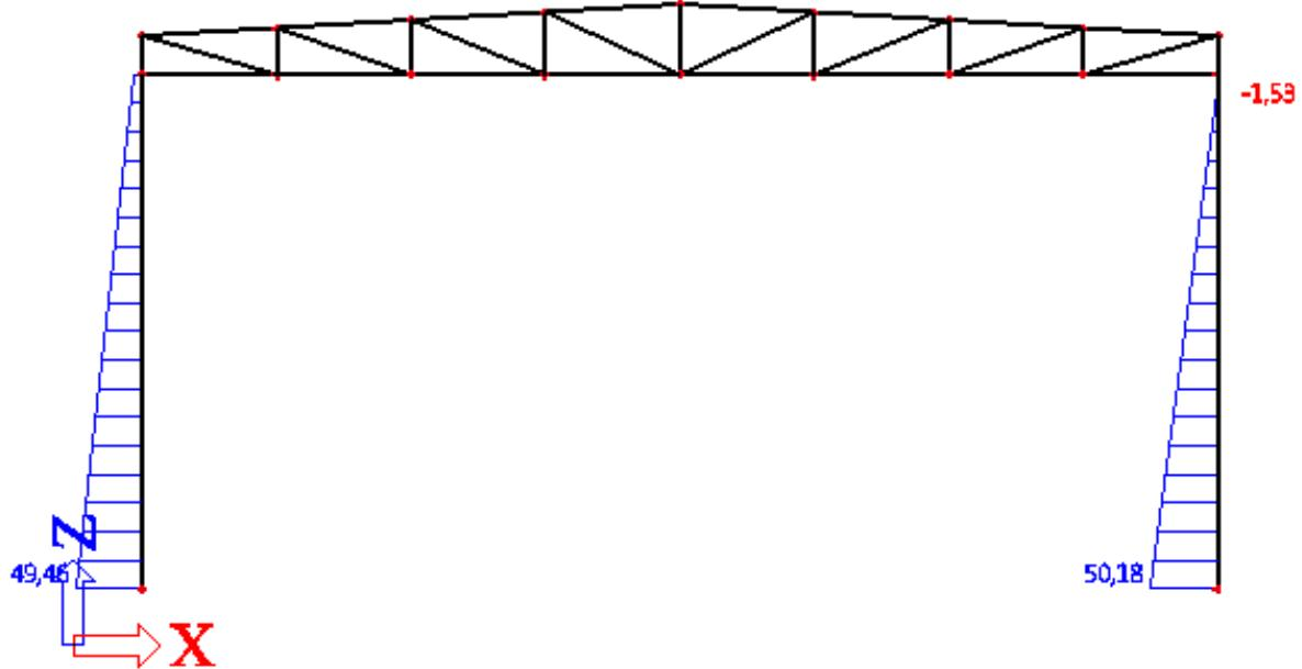
Slika 3.2.11. Dijagram poprečnih sila opterećenja vjetrom W1
