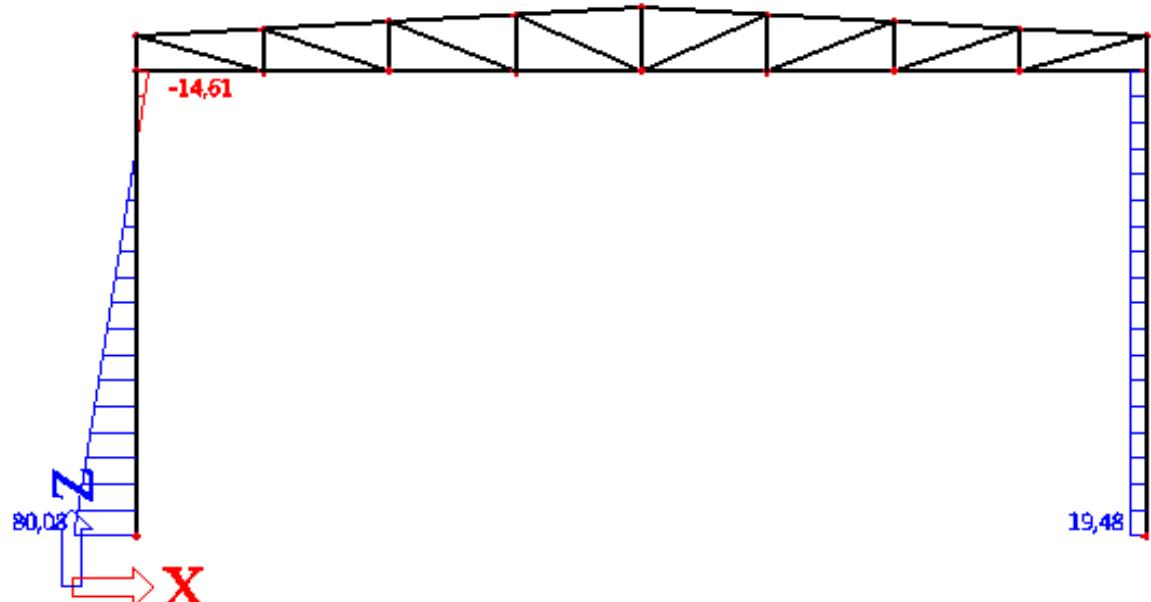
Slika 3.2.14. Dijagram poprečnih sila opterećenja vjetrom W2
