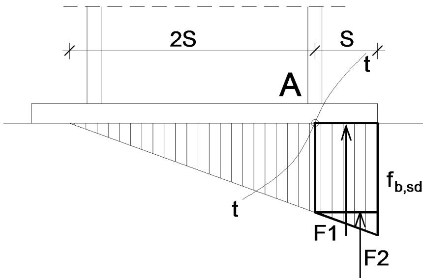
Slika 6.1.3. opterećenje koje djeluje na pločicu
