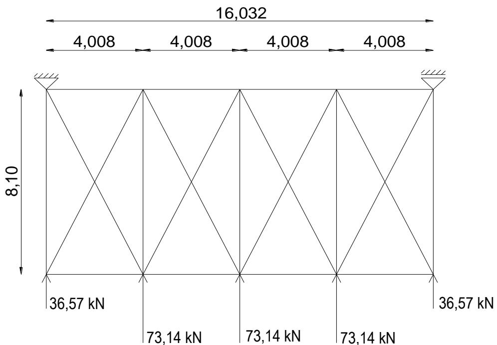
Slika 3.1.1. Raspored krovnih spregova i opterećenje
