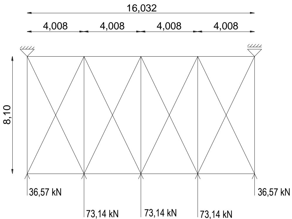
Slika 2.3.4. Raspored krovnih spregova i opterećenje
