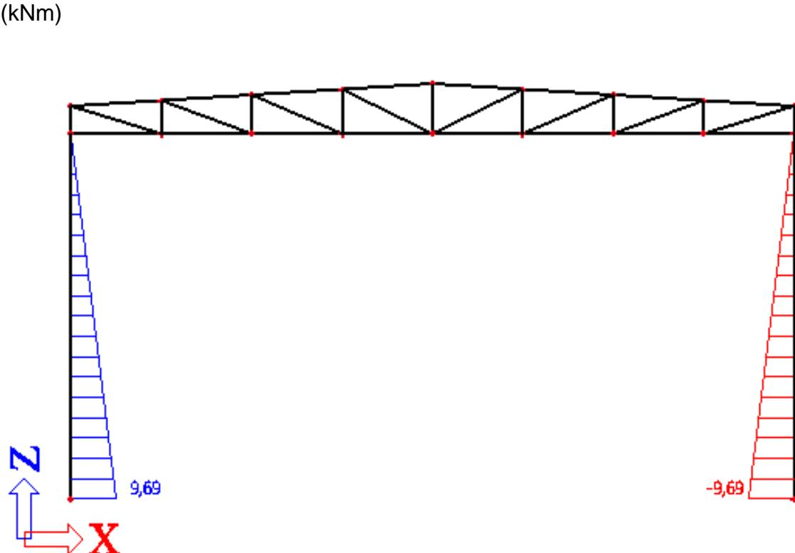
Slika 3.2.4. Momentni dijagram stalnog opterećenja
