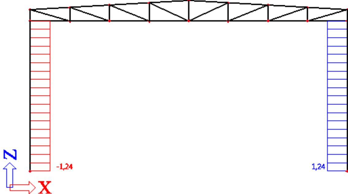
Slika 3.2.5. Dijagram poprečnih sila stalnog opterećenja
