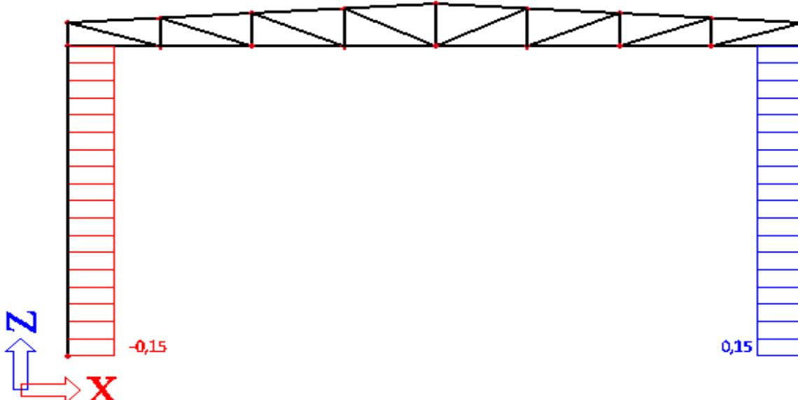
Slika 3.2.2. Dijagram poprečnih sila vlastite težine konstrukcije
