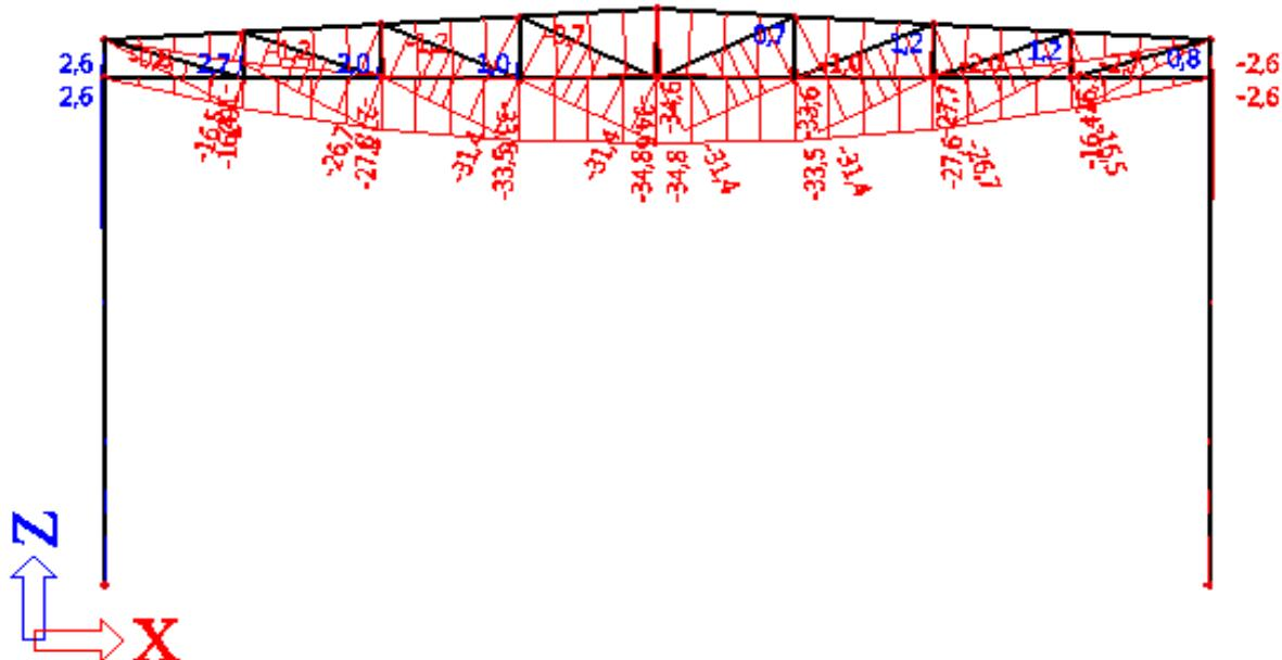
Slika 4.1.1. Vertikalni pomak rešetke
