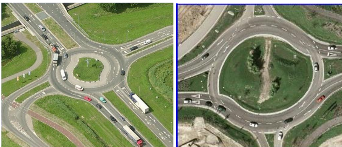
Slika 39. Turbo kružni tok u Nizozemskoj i Njemačkoj
