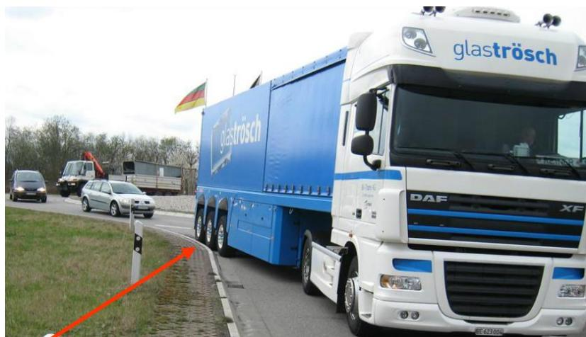
**Slika 32.** Izlaženje kotača velikih vozila van gabarita
