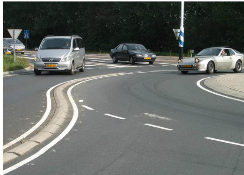
**Slika 46.** Niski rubnjaci unutar kružnog toka u Nizozemskoj
