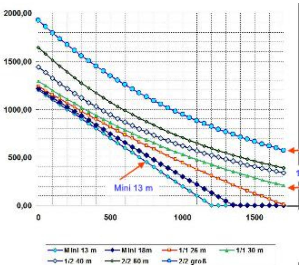
**Slika 47.** Ulazni kapaciteti pojedinih kružnih tokova (ordinata) i količina prometa unutar kružnog toka (apscisa). Brojevi predstavljaju brojeve trakova (ulaz/kružni dio) zajedno sa promjerom u metrima
