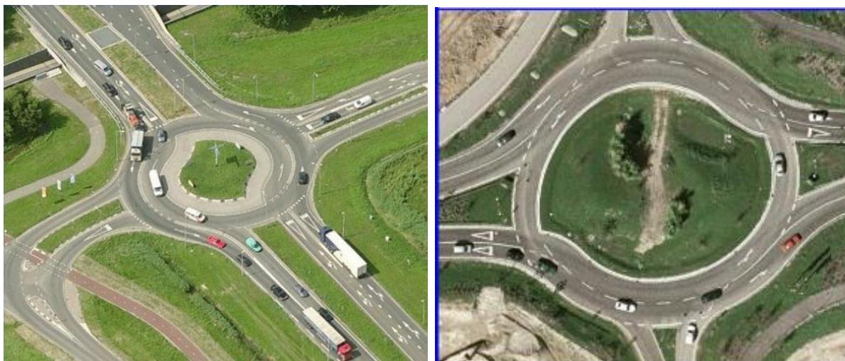
**Slika 39.** Turbo kružni tok u Nizozemskoj i Njemačkoj
