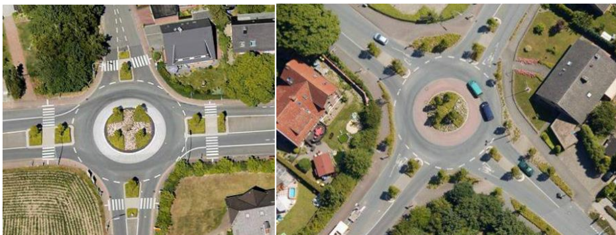
Slika 23. Prijelaz sa zebrom (lijevo) i bez zebre (desno)
