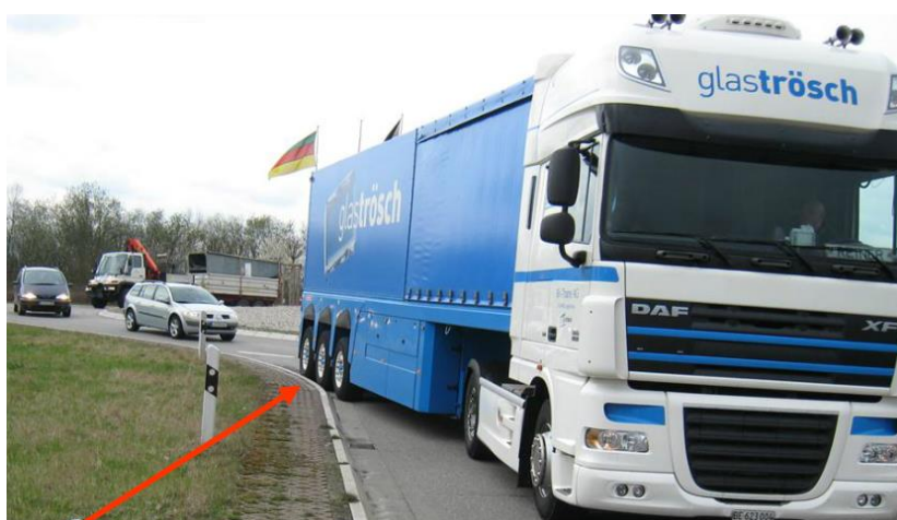
Slika 32. Izlaženje kotača velikih vozila van gabarita
