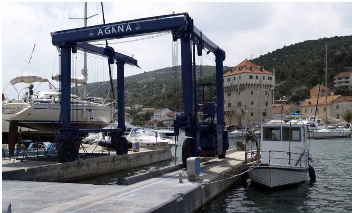
Portalna dizalica dužine okvira 6m, nosivosti 60 tona
