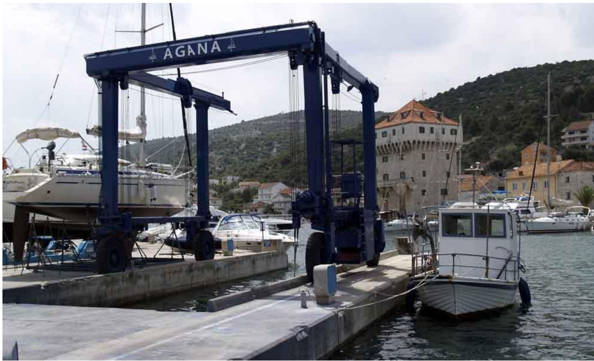
Portalna dizalica dužine okvira 6m, nosivosti 60 tona
