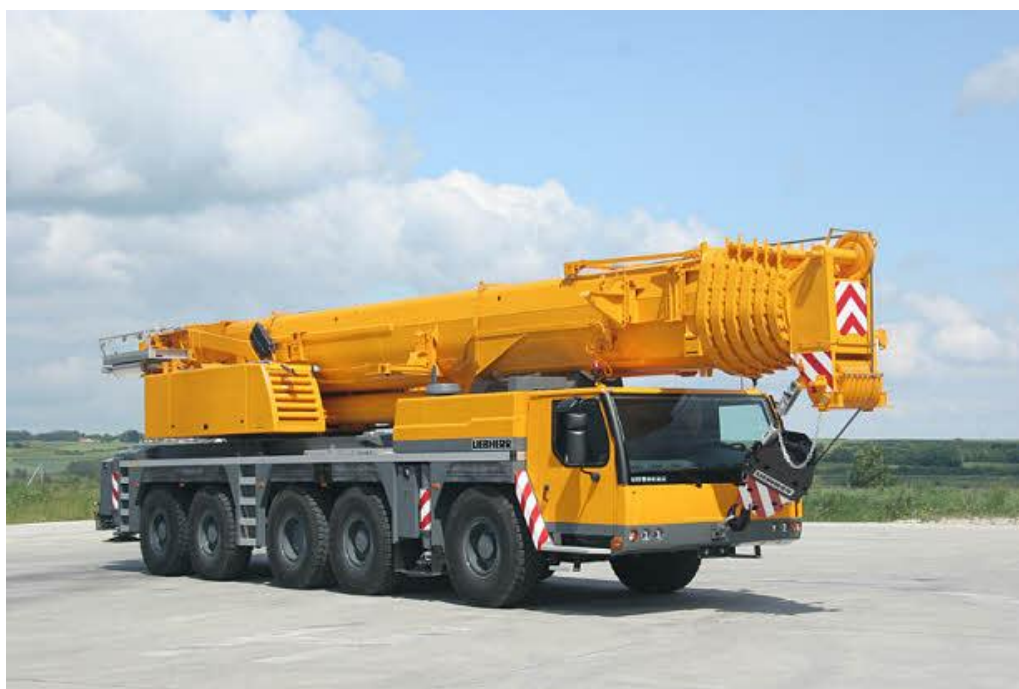
Liebherr mobilna dizalica LTM 1200-5.1, 200- tonska dizalica.
