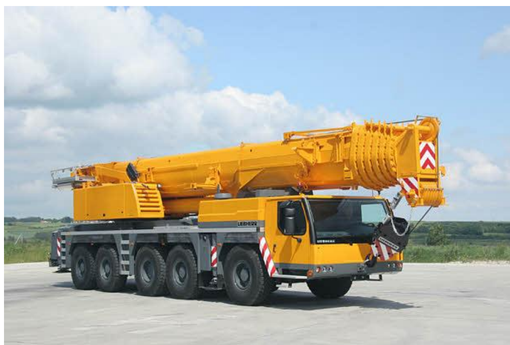
Liebherr mobilna dizalica LTM 1200-5.1, 200- tonska dizalica.
