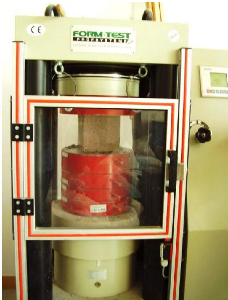
Slika 5.8. Ispitivanje tlačne čvrstoće [slika zabilježena tijekom ispitivanja]
