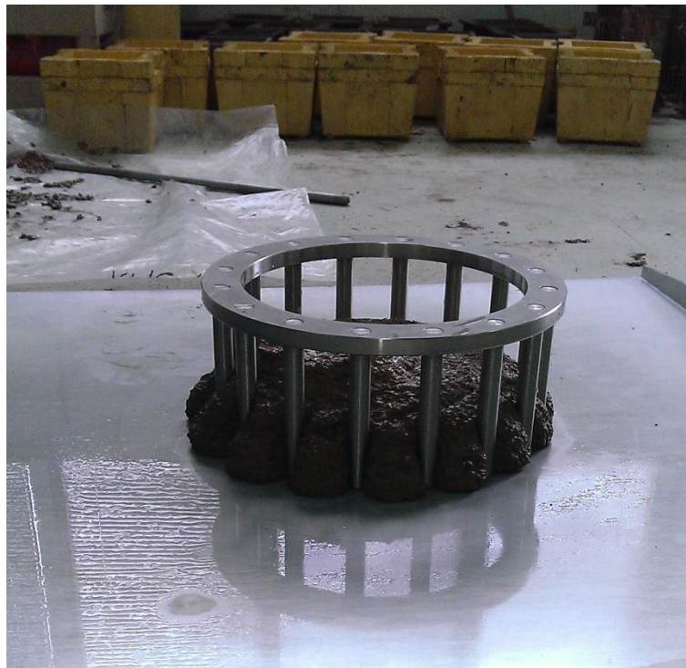
Slika 5.10. J-Ring (slika zabilježena tijekom ispitivanja, mješavina 11)
