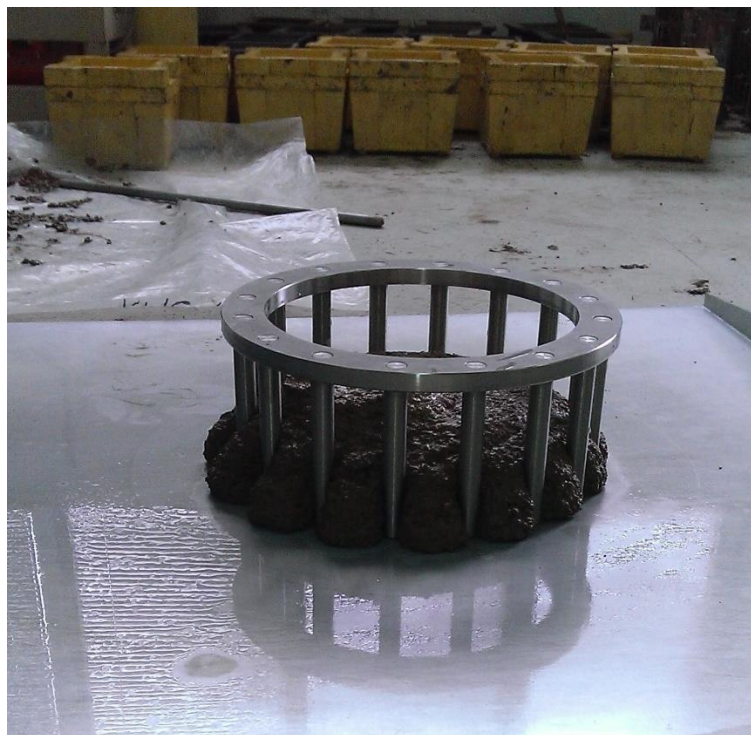
Slika 5.10. J-Ring (slika zabilježena tijekom ispitivanja, mješavina 11)
