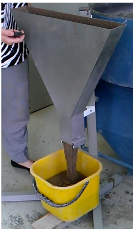
Slika 5.2. V-lijevak [slika zabilježena tijekom ispitivanja]
