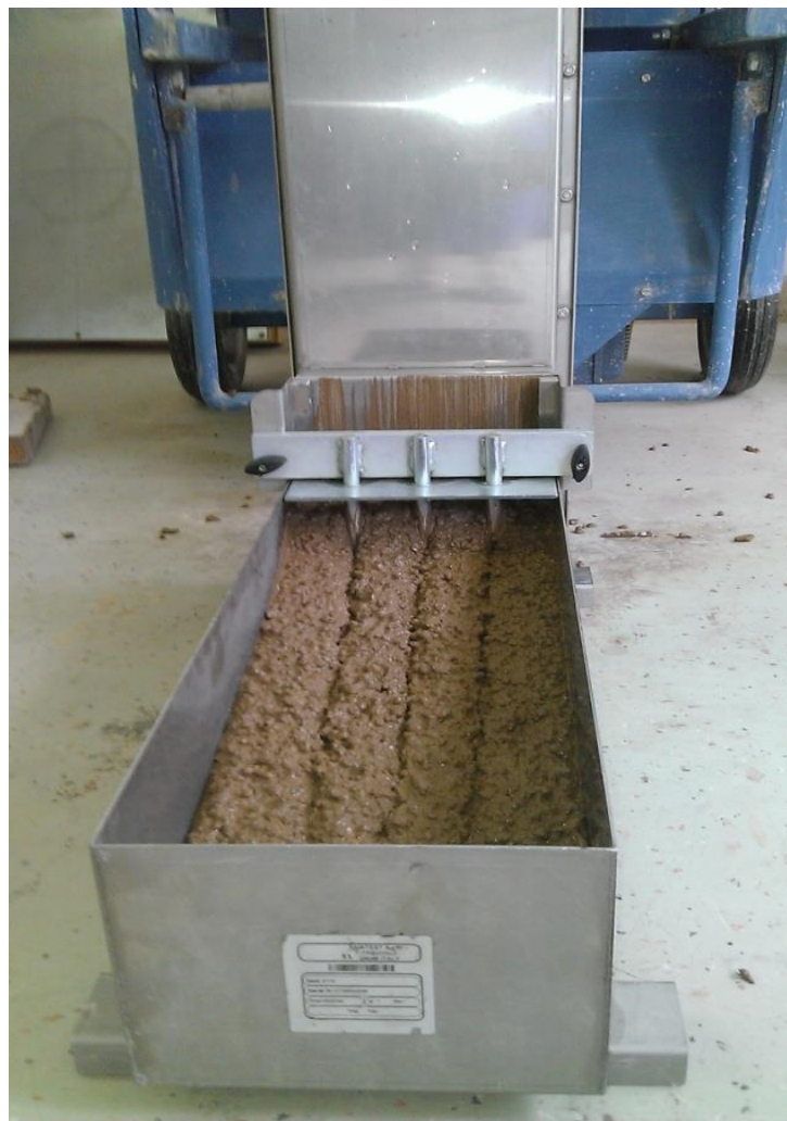
Slika 5.9. L-box [slika zabilježena tijekom ispitivanja, mješavina 11]
