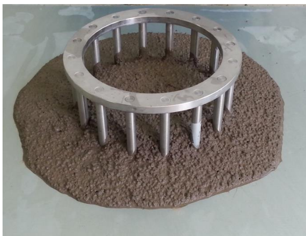
Slika 5.5. Ispitivanje J-prstenom [slika zabilježena tijekom ispitivanja]
