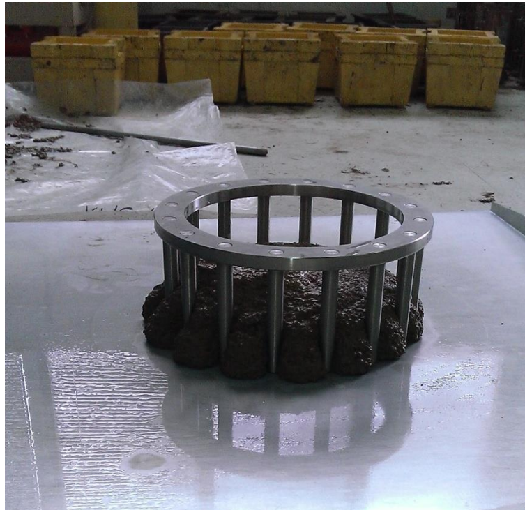
Slika 5.10. J-Ring (slika zabilježena tijekom ispitivanja, mješavina 11)
