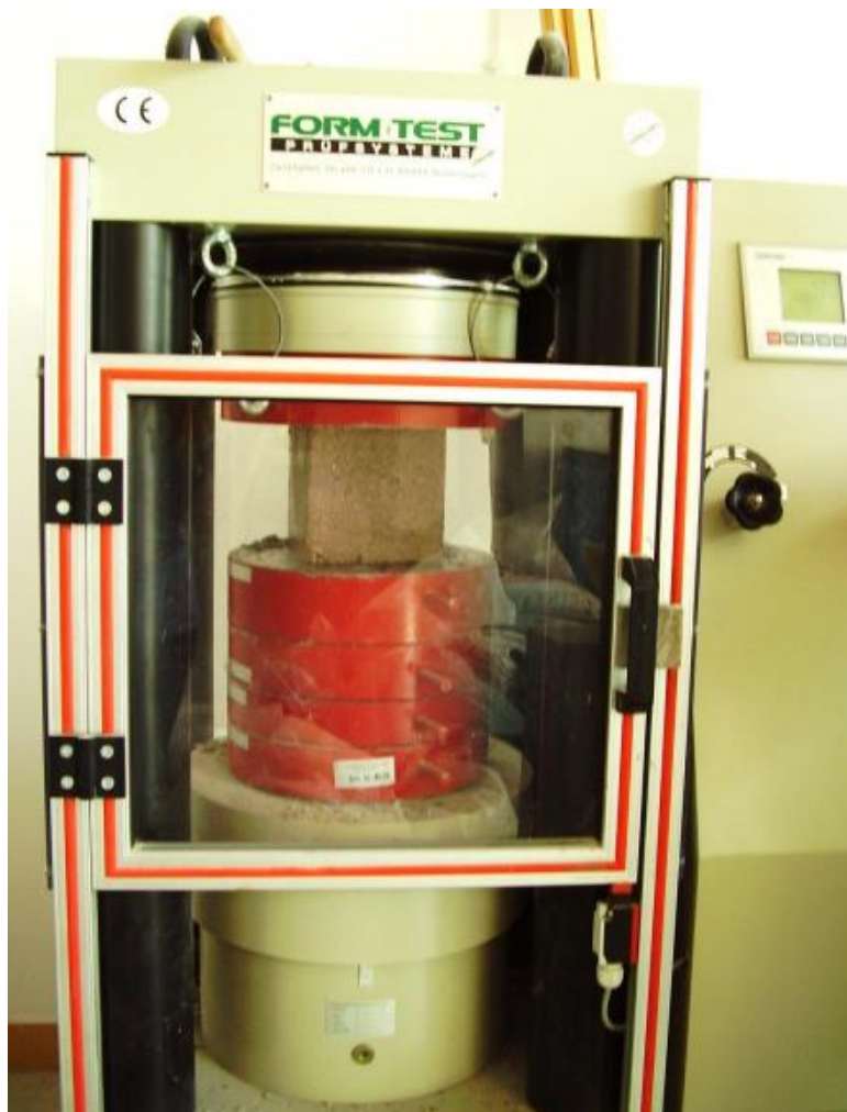
Slika 5.8. Ispitivanje tlačne čvrstoće [slika zabilježena tijekom ispitivanja]
