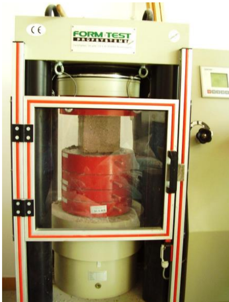
Slika 5.8. Ispitivanje tlačne čvrstoće [slika zabilježena tijekom ispitivanja]
