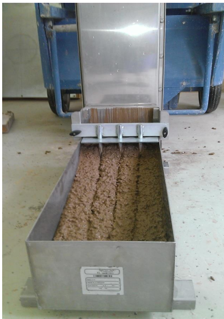
Slika 5.9. L-box [slika zabilježena tijekom ispitivanja, mješavina 11]
