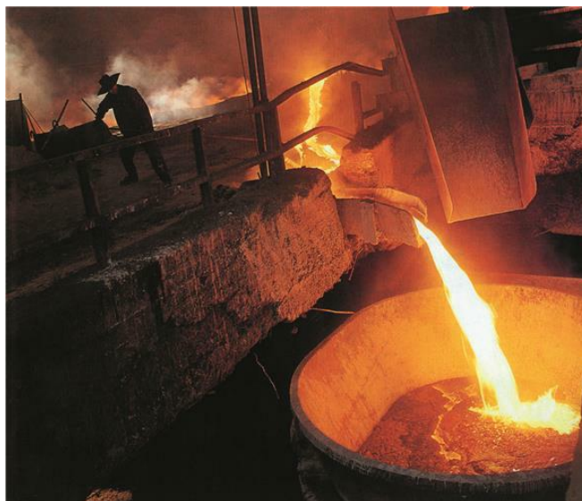
Slika 2.6. Zgura(crno) "pluta" na rastaljenom metalu. [11]
