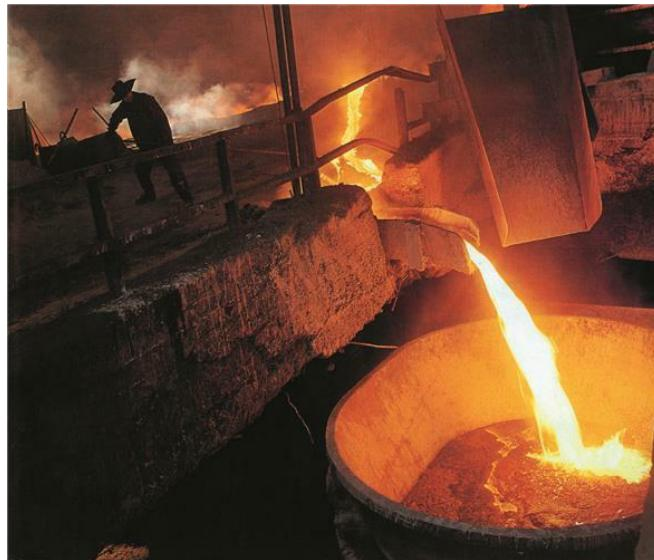
**Slika 2.6.** Zgura(crno) "pluta" na rastaljenom metalu. [11]
