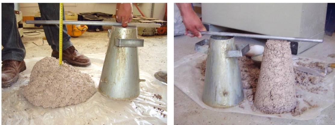
Slika 4.6. Slijeganje mješavine LB6 neposredno nakon miješanja (lijevo), te 30 minuta nakon miješanja (desno). [4]
