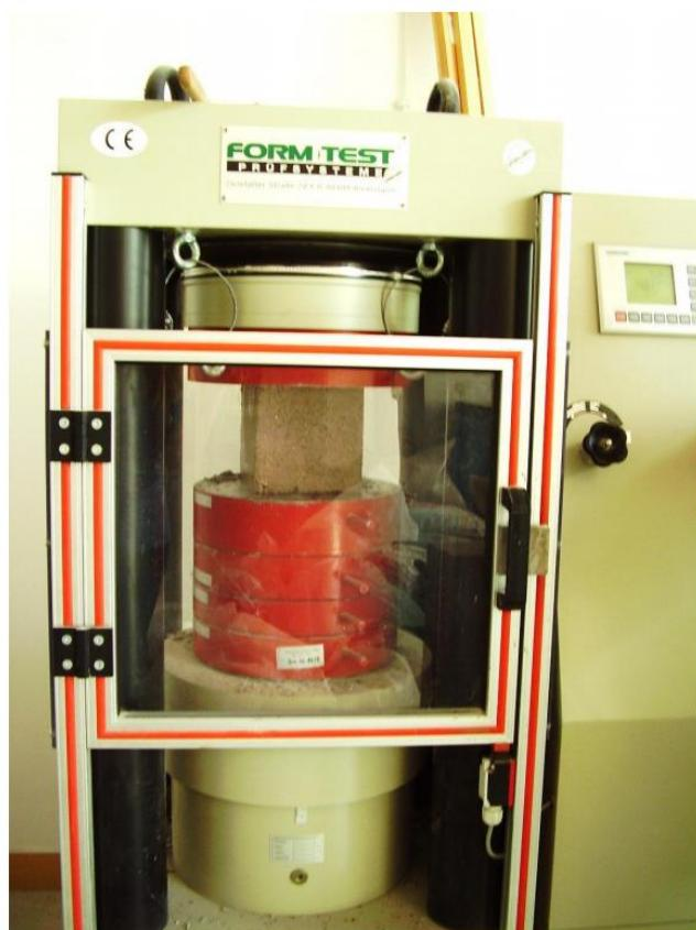
Slika 4.8. Ispitivanje tlačne čvrstoće [4]
