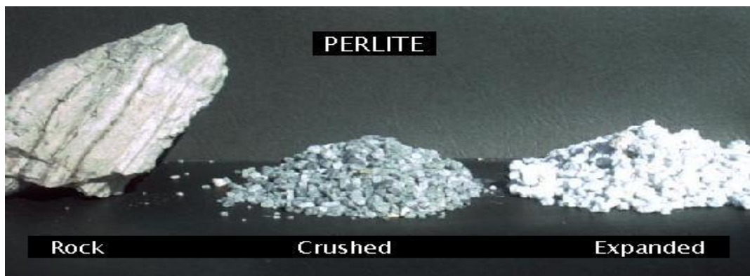
Slika 2.4. Izgled perlita u procesima obrade [9]
