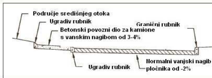
Slika 11. Uobičajeni presjek s povoznim dijelom za kamione
