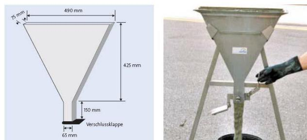
*Slika 4.2. V- lijevak test (V- funnel) [2]*
