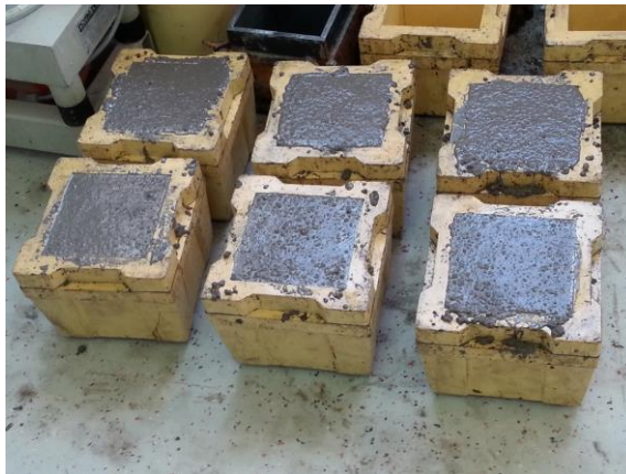
Slika 4.8. Uzorci svježeg betona [slika zabilježena tijekom ispitivanja]
