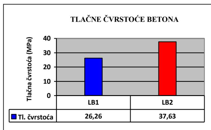
**Dijagram 4.5.** Tlačne čvrstoće betona nakon 7 dana
