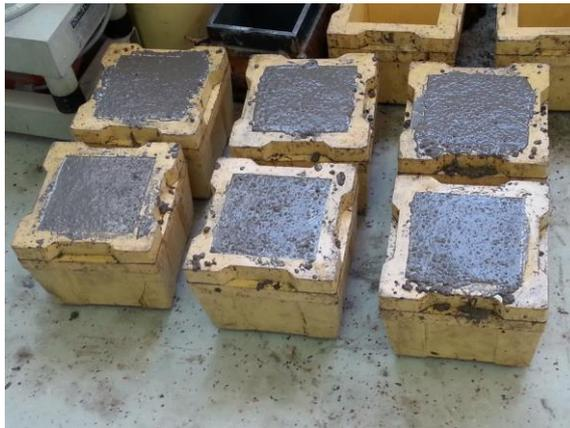
**Slika 4.8.** Uzorci svježeg betona [slika zabilježena tijekom ispitivanja]
