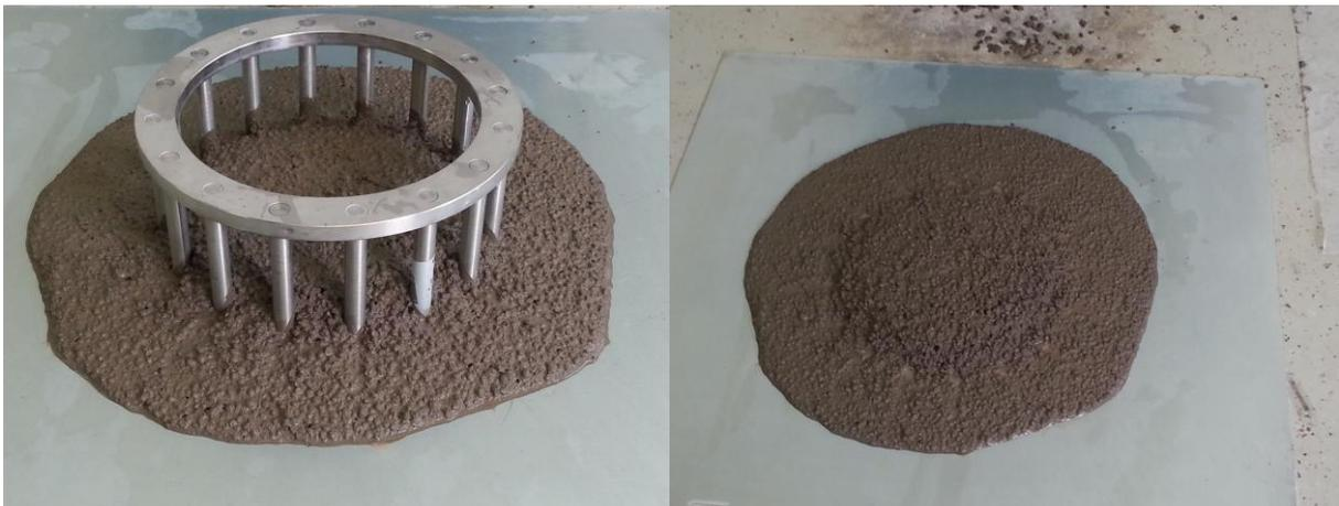
*Slika 4.5. Ispitivanje J- prstenom [slika zabilježena tijekom ispitivanja]*
