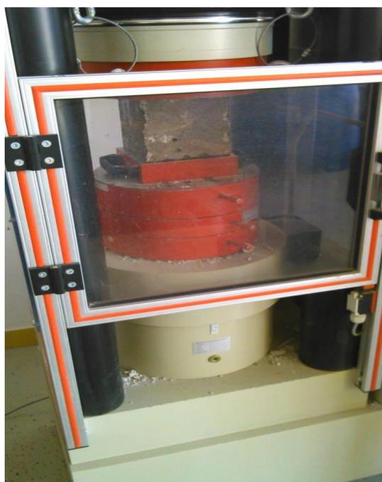
*Slika 4.9. Ispitivanje tlačne čvrstoće [slika zabilježena tijekom ispitivanja]*
