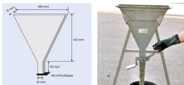
Slika 4.2. V- lijevak test (V- funnel) [2]
