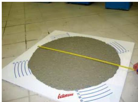
**Slika 4.3.** Mjerenje promjera razastiranja [2]
