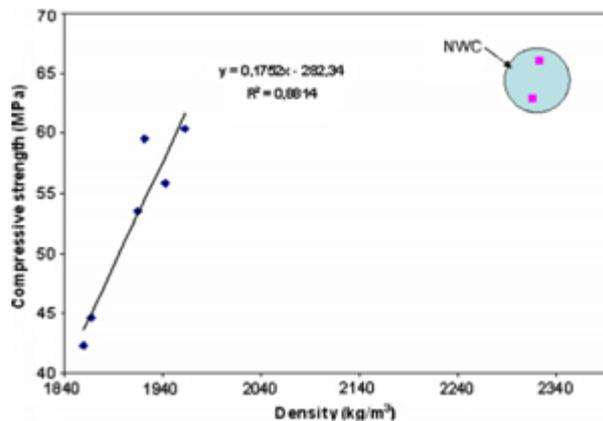
*Dijagram 3.2. Omjer tlačne čvrstoće i gustoće [5]*
