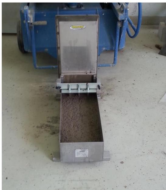
*Slika 4.4. L- box uređaj [slika zabilježena tijekom ispitivanja]*
