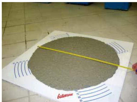
Slika 4.3. Mjerenje promjera razastiranja [2]
