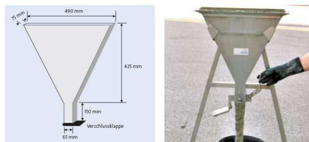
Slika 4.2. V- lijevak test (V- funnel) [2]
