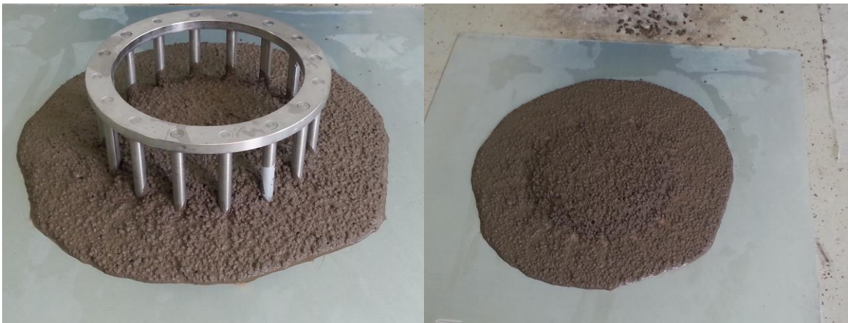
Slika 4.5. Ispitivanje J- prstenom [slika zabilježena tijekom ispitivanja]
