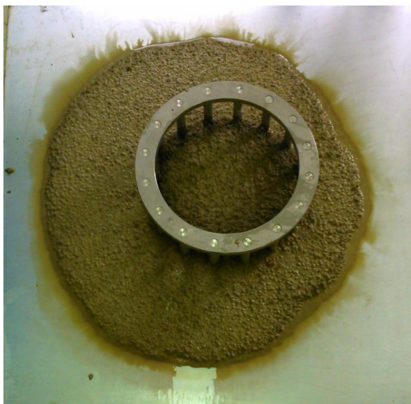
Slika 4.10. J-prsten (J-ring)[slika zabilježena tijekom ispitivanja]
