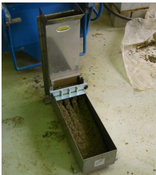
Slika 4.9. L-box [slika zabilježena tijekom ispitivanja]
