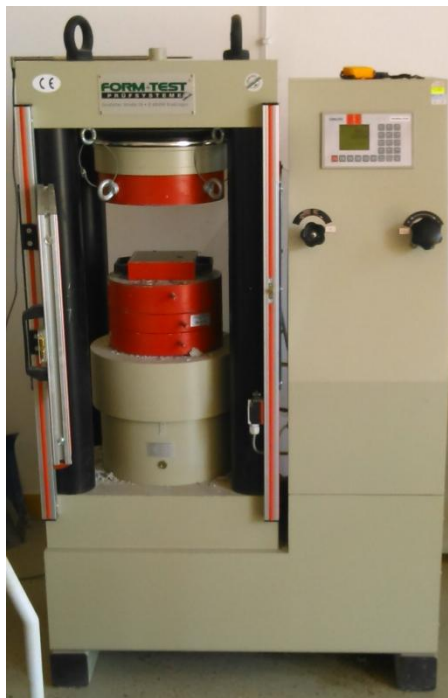
Slika 4.6. Preša za ispitivanje čvrstoće na pritisak
