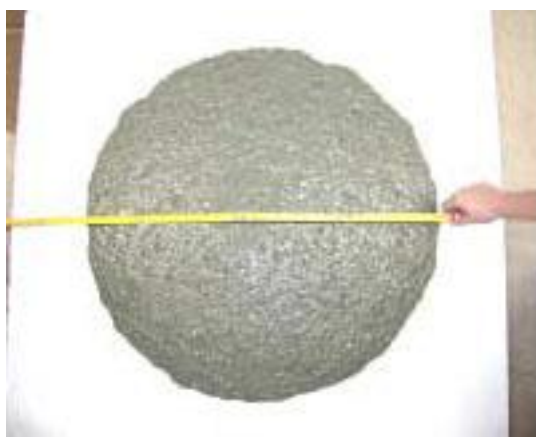
Slika 4.2. Metoda razastiranja (Slump-flow) [5]
