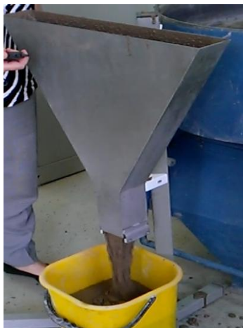
Slika 4.1. V-lijevak [slika zabilježena tijekom ispitivanja]
