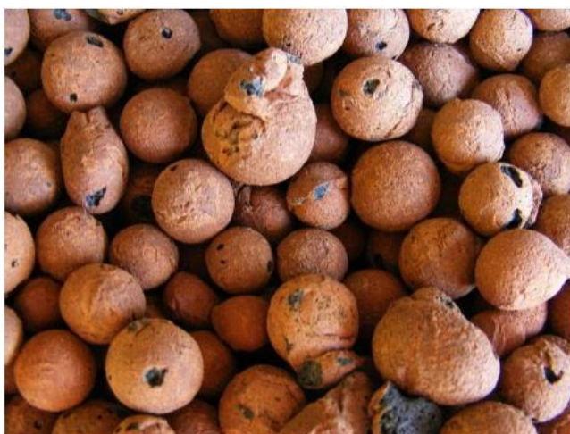
Slika 2.7. glinopor ili kermazit [4]
