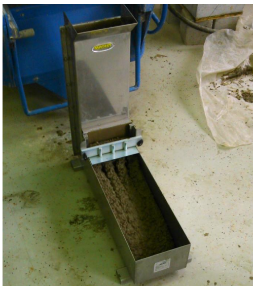
Slika 4.9. L-box [slika zabilježena tijekom ispitivanja]
