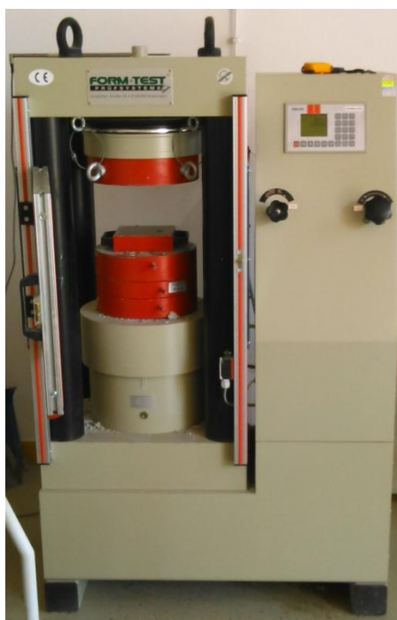
Slika 4.6. Preša za ispitivanje čvrstoće na pritisak
