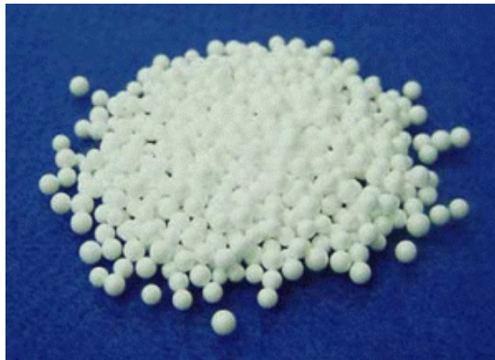
Slika 2.4. Ekspandirani polimerni materijal [18]
