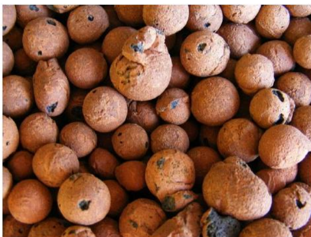
Slika 2.7. glinopor ili kermazit [4]
