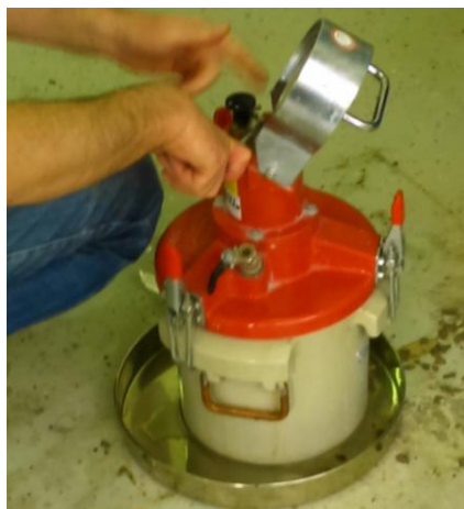
Slika 4.11. Ispitivanje pomoću porometra [slika zabilježena tijekom ispitivanja]
