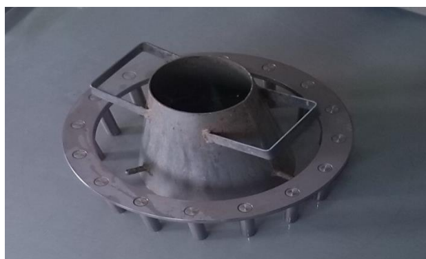
Slika 2.3 Oprema za ispitivanje J-prstenom
