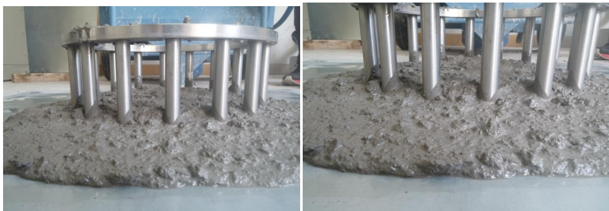
Slika 4.26 Rezultati ispitivanja J-prstenom mješavine SCC3
