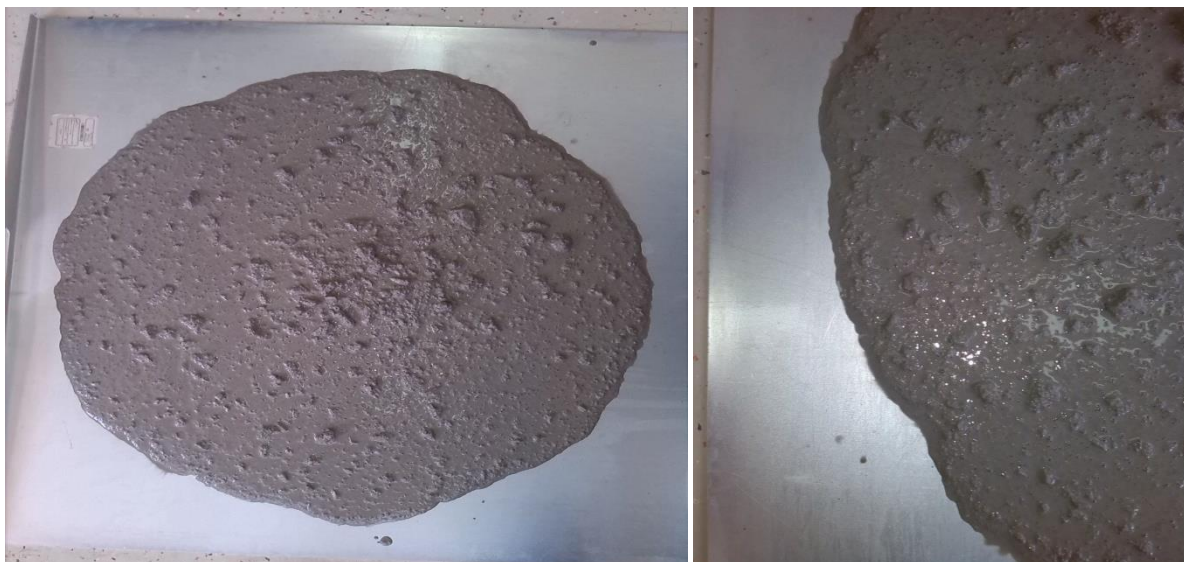
Slika 4.11 Rasprostiranje-slijeganjem mješavina SCC6
