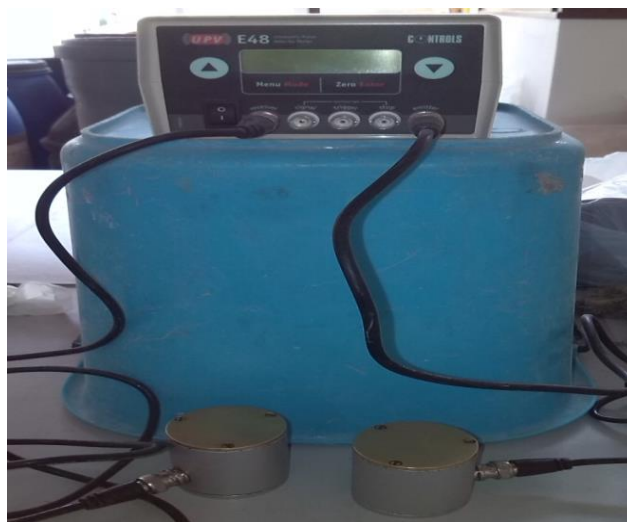
Slika 2.5 Ultrazvučni uređaj CONTROLS UPV E48
