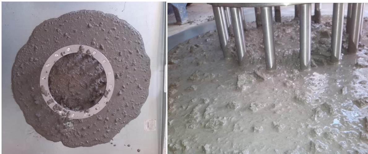
Slika 4.29 Rezultati ispitivanja J-prstenom mješavine SCC6
