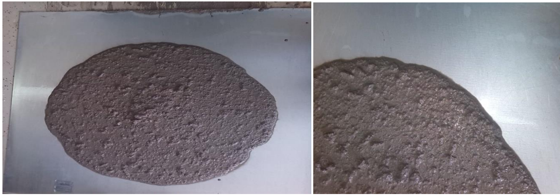
Slika 4.10 Rasprostiranje-slijeganjem mješavina SCC5
