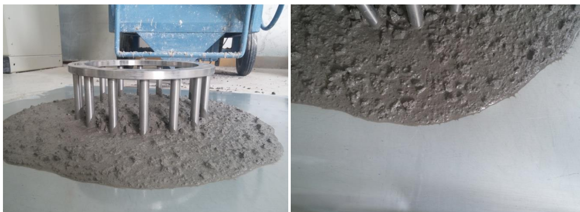
Slika 4.25 Rezultati ispitivanja J-prstenom mješavine SCC2
