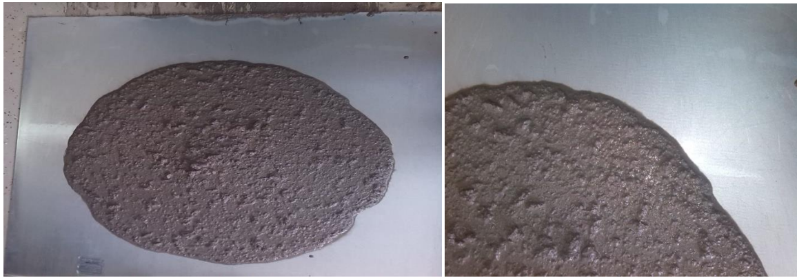
Slika 4.10 Rasprostiranje-slijeganjem mješavina SCC5
