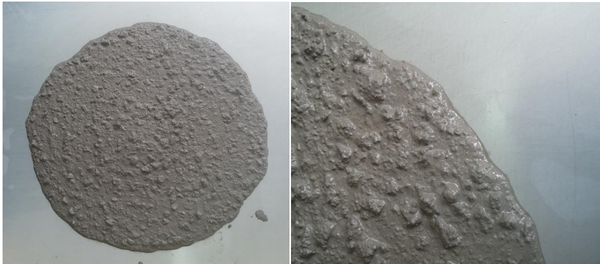
Slika 4.8 Rasprostiranje-slijeganjem mješavina SCC3
