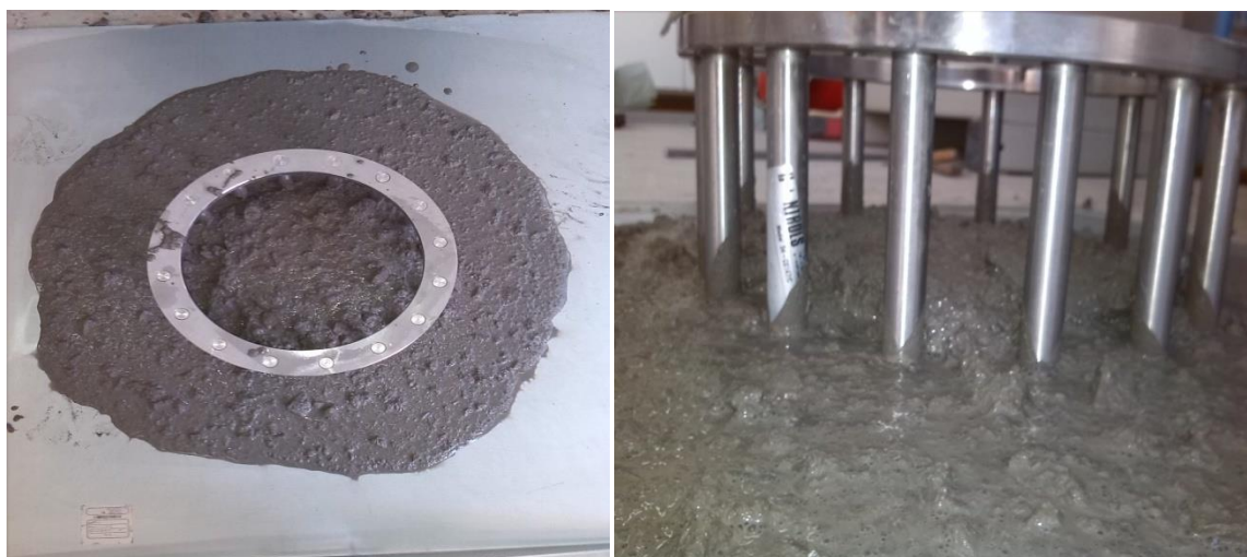
Slika 4.27 Rezultati ispitivanja J-prstenom mješavine SCC4
