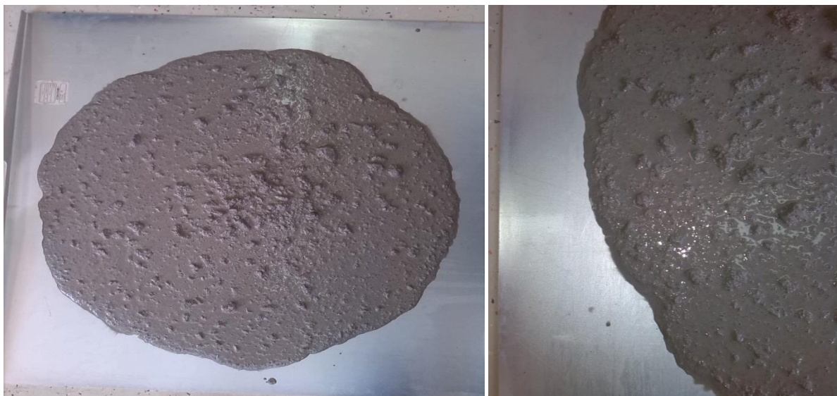
Slika 4.11 Rasprostiranje-slijeganjem mješavina SCC6
