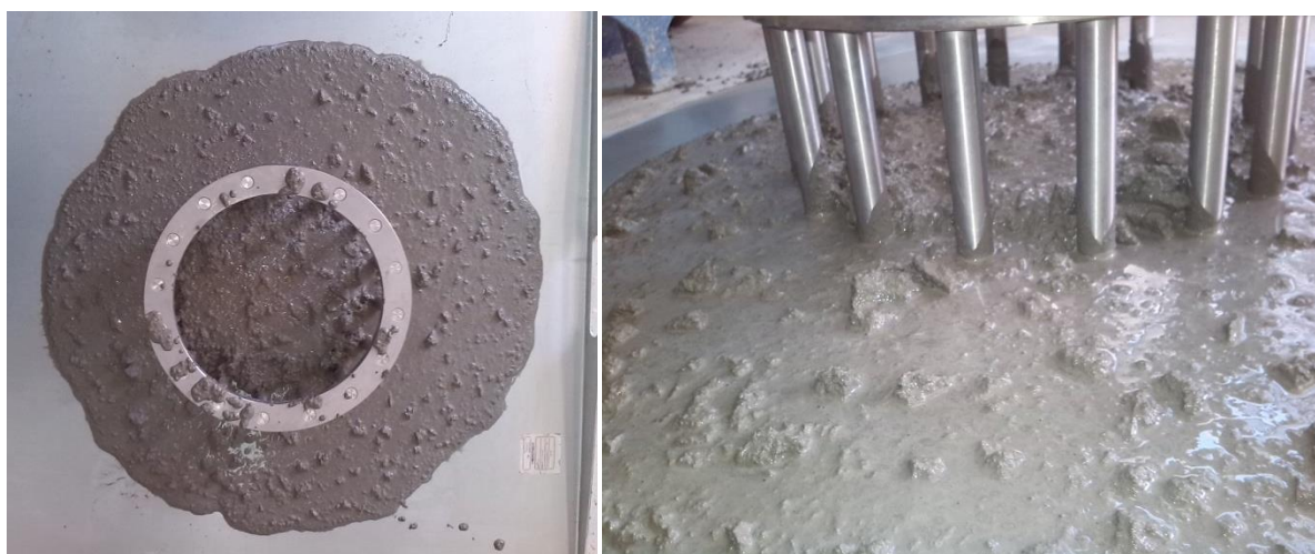
Slika 4.29 Rezultati ispitivanja J-prstenom mješavine SCC6
