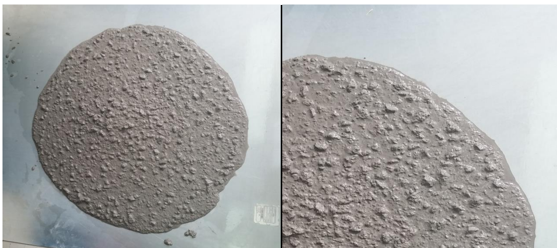
Slika 4.7 Rasprostiranje-slijeganjem mješavina SCC2
