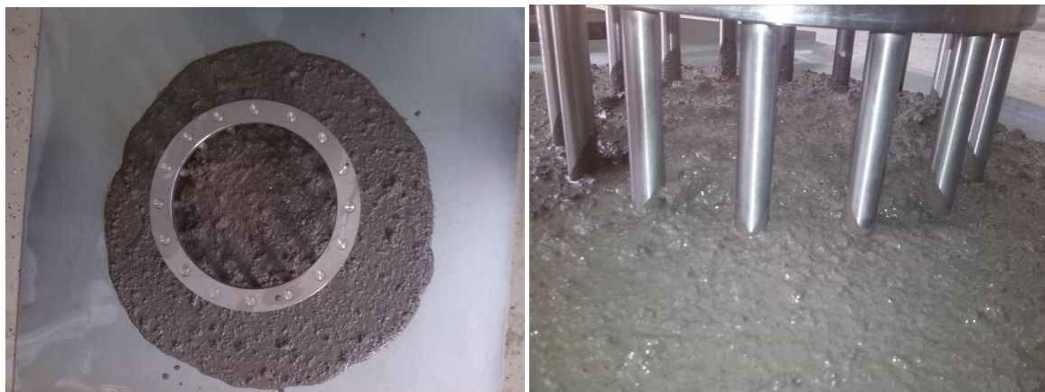
Slika 4.28 Rezultati ispitivanja J-prstenom mješavine SCC5
