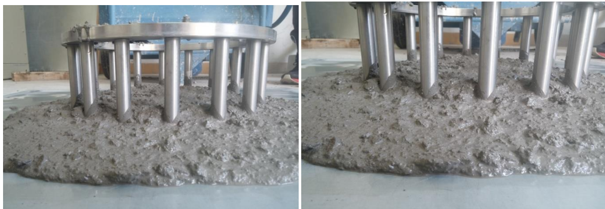
Slika 4.26 Rezultati ispitivanja J-prstenom mješavine SCC3
