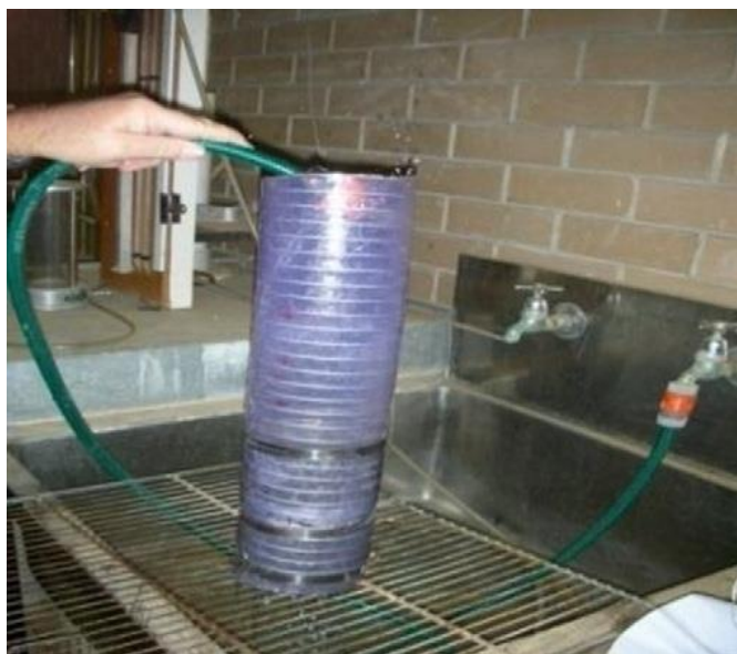
Slika 3.3 Ispitivanje vodopropusnosti poroznog betona [9]
