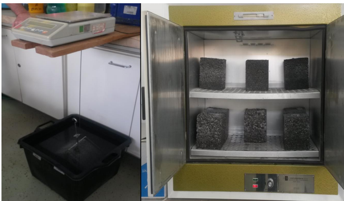
Slika 5.2 Mjerenje mase uzorka u vodi i sušenje uzoraka u pećnici
