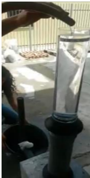
Slika 5.4 Ispitivanje propusnosti metodom stalne razine stupca vode
