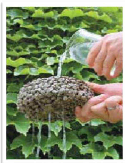
Slika 1.1 Tipični izgled i karakteristike poroznog betona [3].
