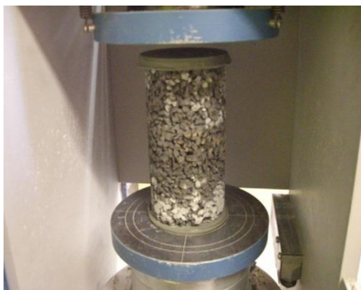
Slika 3.2 Ispitivanje vlačne čvrstoće [9]
