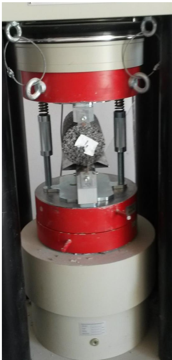
Slika 5.7 Preša za ispitivanje vlačne čvrstoće cijepanjem
