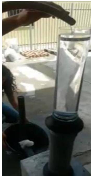
Slika 5.4 Ispitivanje propusnosti metodom stalne razine stupca vode
