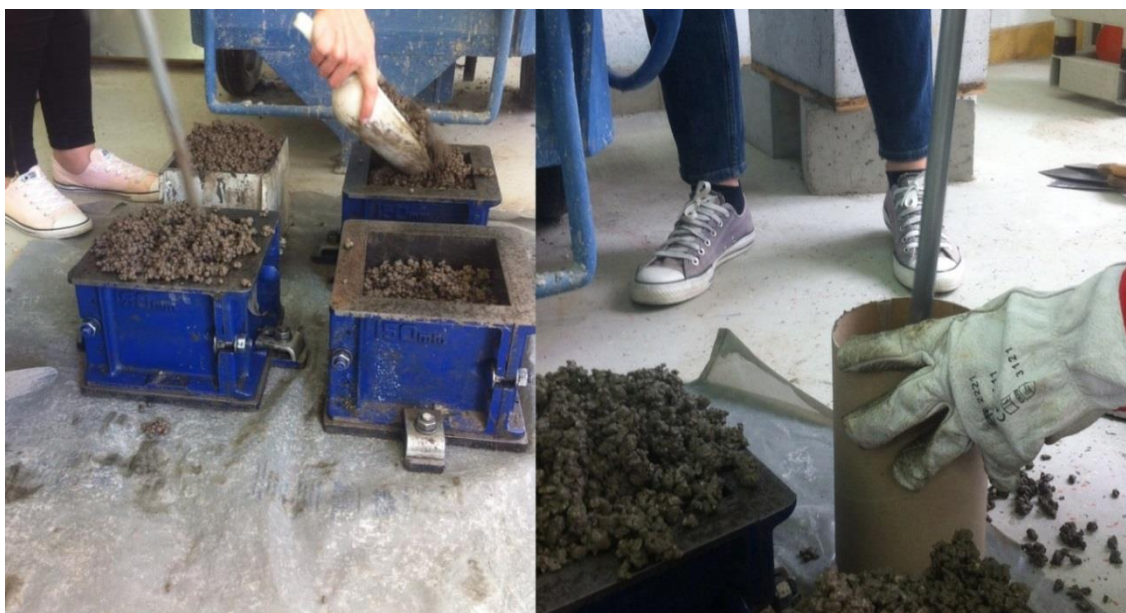
Slika 4.4 Izrada uzoraka od poroznog betona
