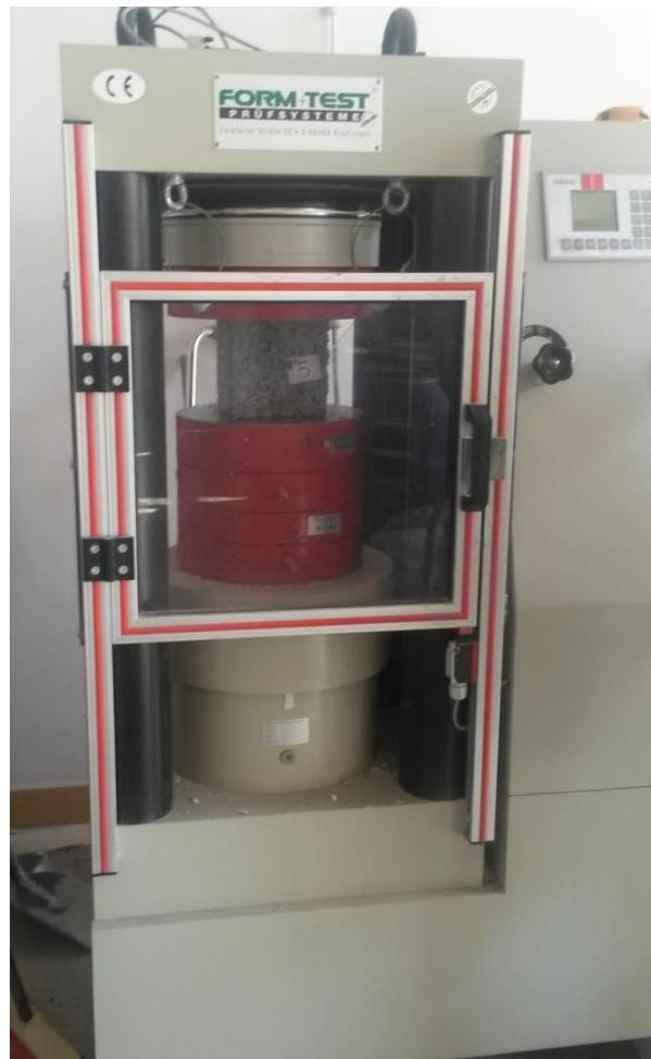
Slika 5.5 Preša za mjerjenje tlačne čvrstoće
