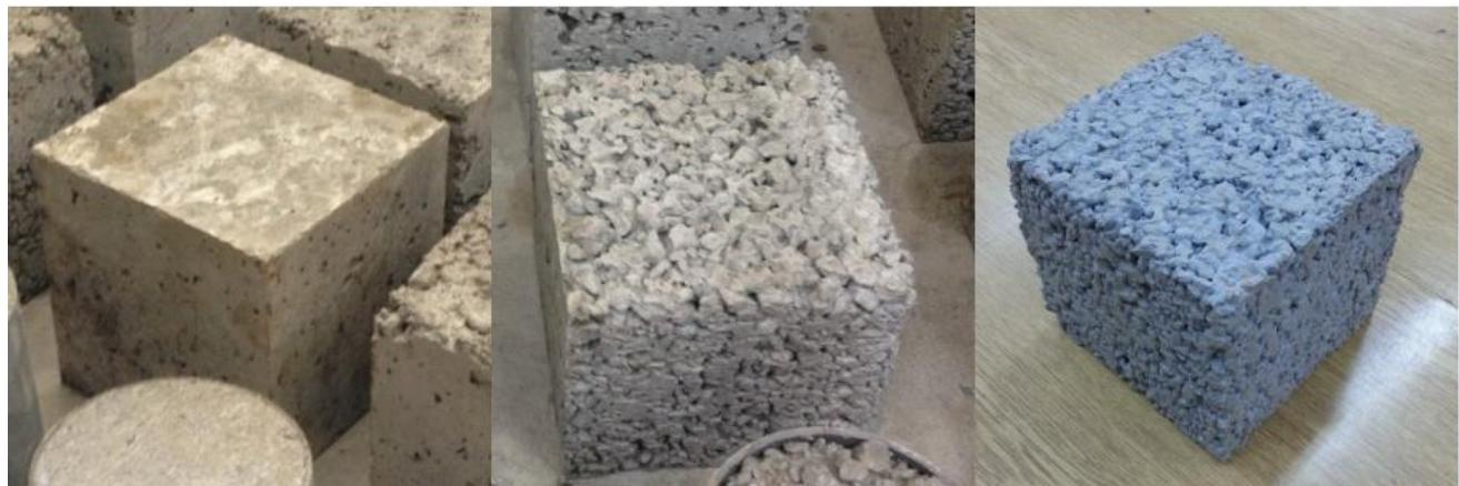
Slika 3.1 Uzorci očvrslog betona, redom: M1, M2, M3 [5]
