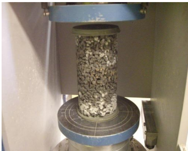
Slika 3.2 Ispitivanje vlačne čvrstoće [9]
