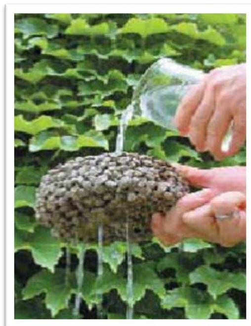
Slika 1.1 Tipični izgled i karakteristike poroznog betona [3].
