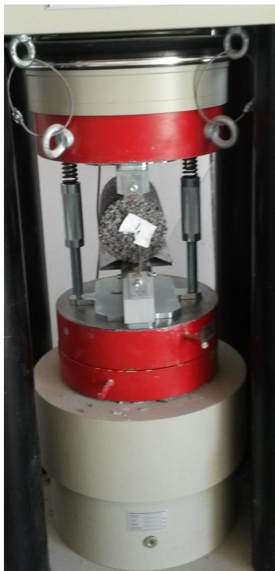
Slika 5.7 Preša za ispitivanje vlačne čvrstoće cijepanjem
