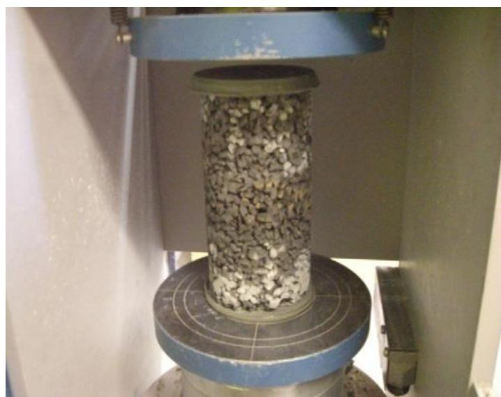
Slika 3.2 Ispitivanje vlačne čvrstoće [9]
