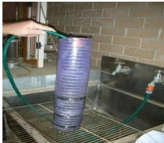
Slika 3.3 Ispitivanje vodopropusnosti poroznog betona [9]
