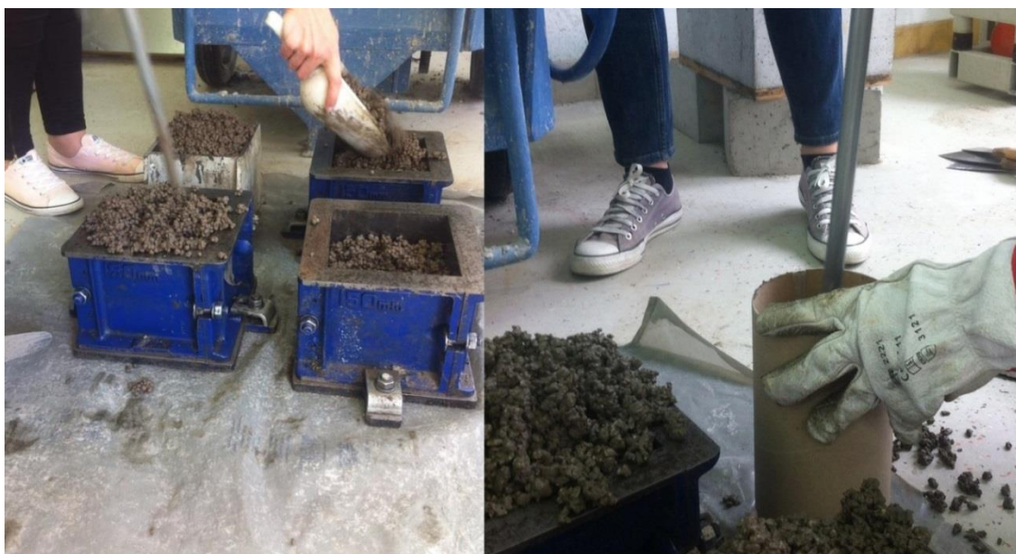
Slika 4.4 Izrada uzoraka od poroznog betona
