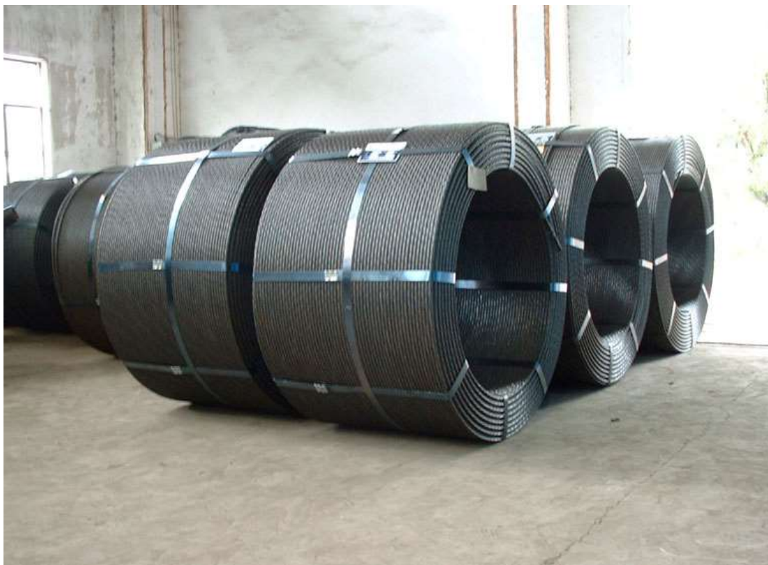
Slika 3.6 Čelik za prednapinjanje u kolotovima [11]
