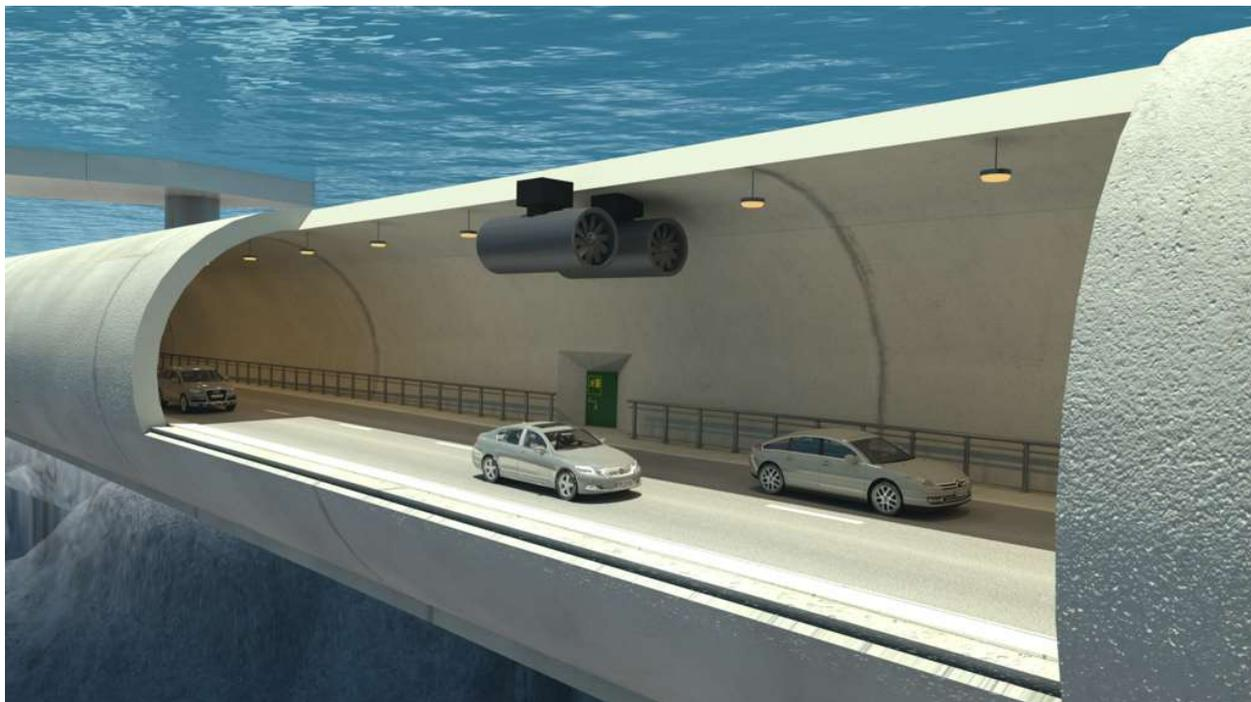
Slika 2.20 Primjer modela potopljenih plutajućih tunela [7]
