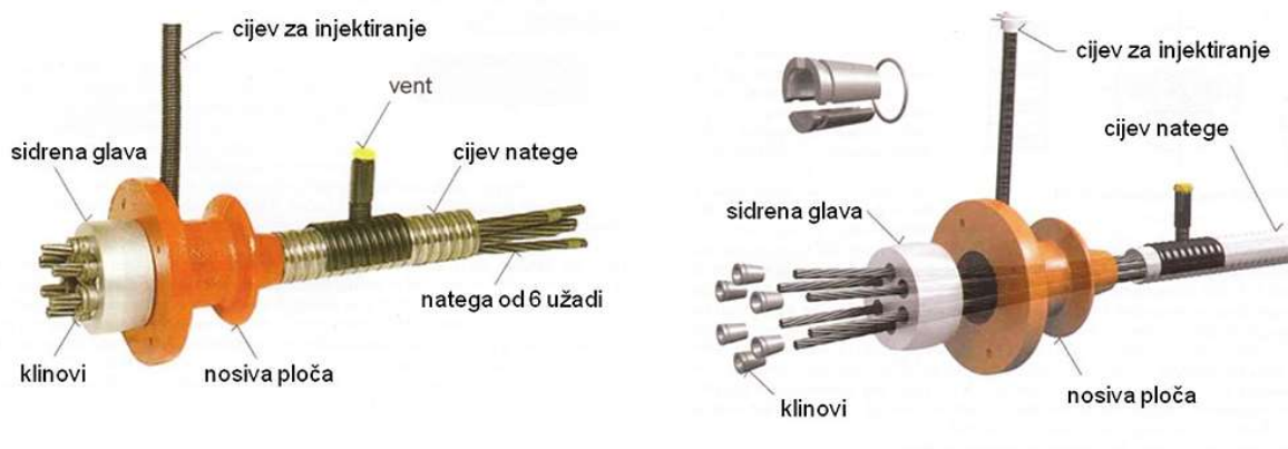
Slika 3.13 Sidro sustava prednapinjanja SOLO [9]
