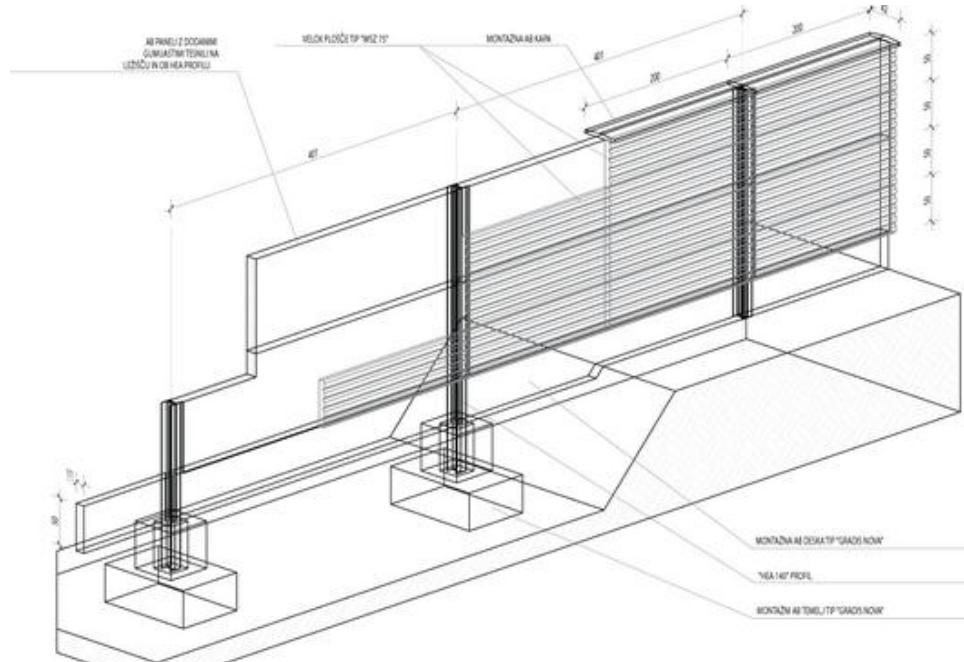
Slika 6.3. Betonski paneli za zaštitu od buke [39]
