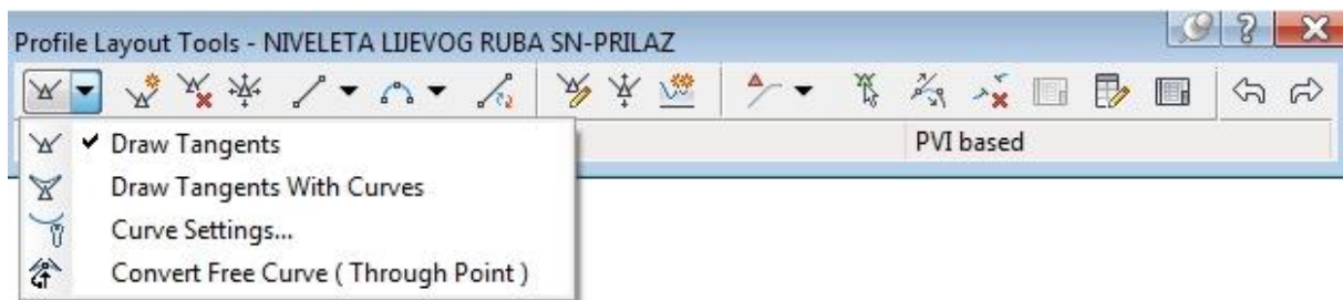
Slika 6.15. Postupak dizajniranja uzdužnog profila lijevog ruba SN privoza kružnog raskrižja [9]
