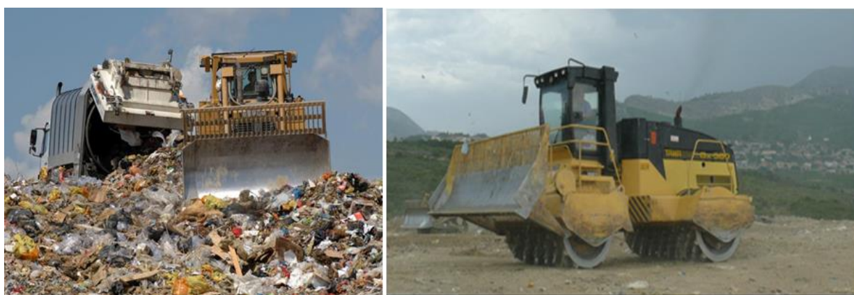
Slika 18. Istovar i razastiranje otpada (lijevo) i kompaktor za zbijanje otpada (desno) na odlagalištu Karepovac
