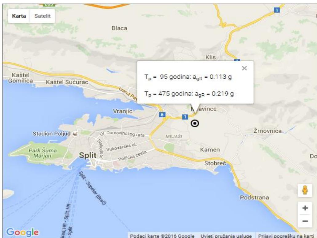
**Slika 13. Iznos horizontalnih vršnih ubrzanja tla tipa A ( $a_{gR}$ ) za povratna razdoblja od  $T_p=95$  i 475 godina, izraženih u jedinicama gravitacijskog ubrzanja ( $1 \text{ g} = 9.81 \text{ m/s}^2$ ) za područje Karepovca (Karte potresnih područja Republike Hrvatske)**
