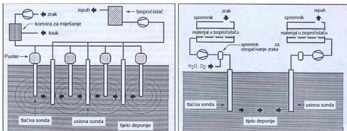
Slika 20. Shematski prikaz BIOPUSTER i SMELL-WELL tehnologije
