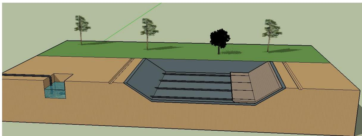
**Slika 26. Shematski prikaz postavljanja drenažnog sloja sa sustavom cijevi (Izvor: autorica diplomskog rada)**
