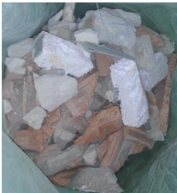
Slika 6.3.: Betonski otpad prije mljevenja
