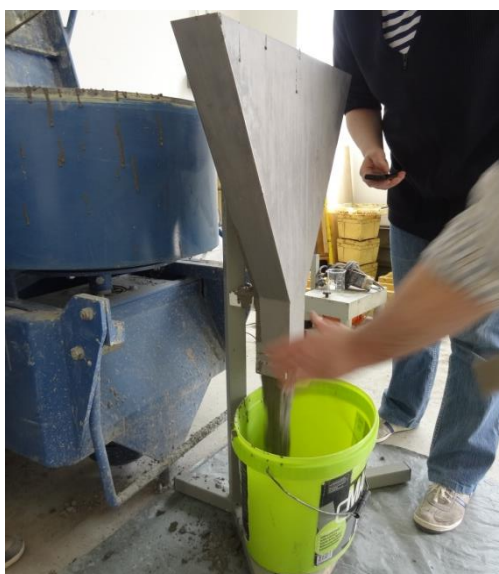
Slika 6.6.: Istjecanje mješavine M8 iz V – lijevka
