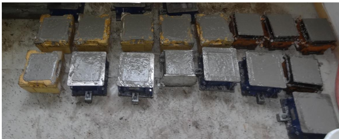
Slika 6.23.: Ugrađeni beton u kalupe (mješavina M5)
