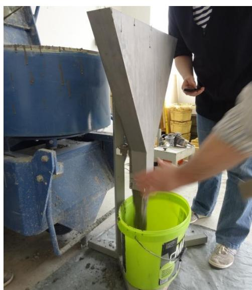
**Slika 6.6.:Istjecanje mješavine M8 iz V – lijevka**
