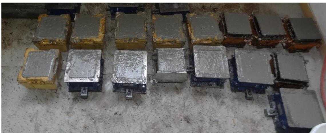
Slika 6.23.: Ugrađeni beton u kalupe (mješavina M5)
