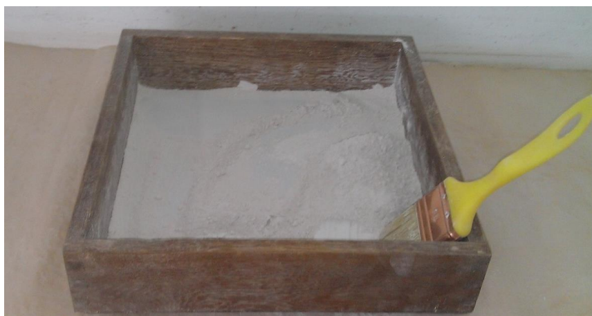
Slika 6.5.: Prosijavanje „bijelog šuta“ na situ 0,04mm
