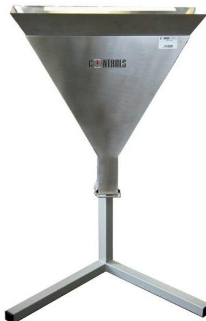
Slika 4.2: V-lijevak sa stalkom [16]
