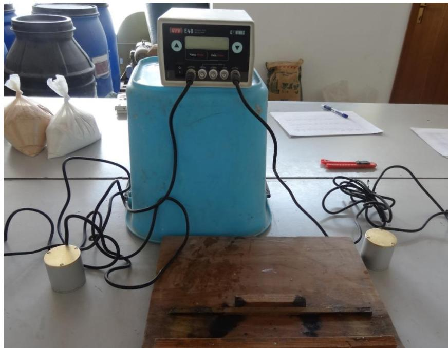
*Slika 6.33.: Uredaj za ispitivanje brzine ultrazvučnih valova*
