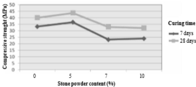
*Slika 5.14.: Tlačna čvrstoća obzirom na količinu kamenog praha[24]*
