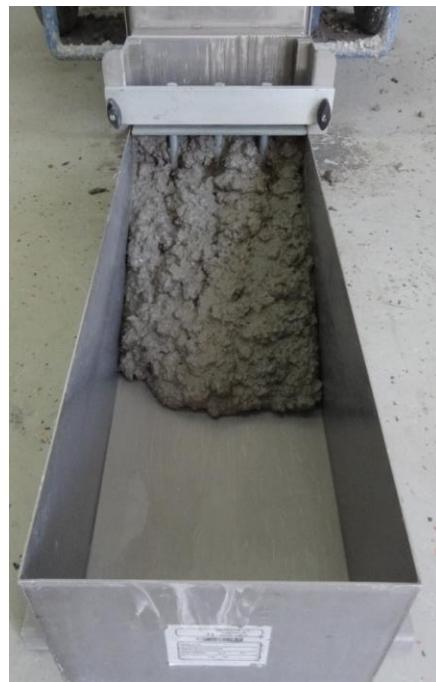
*Slika 6.19.: Ispitivanje L – kutijom (mješavina M1)*
