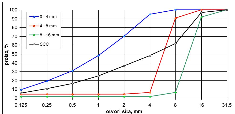
*Slika 6.1.: Granulometrijske krivulje frakcija drobljenog agregata i betona*
