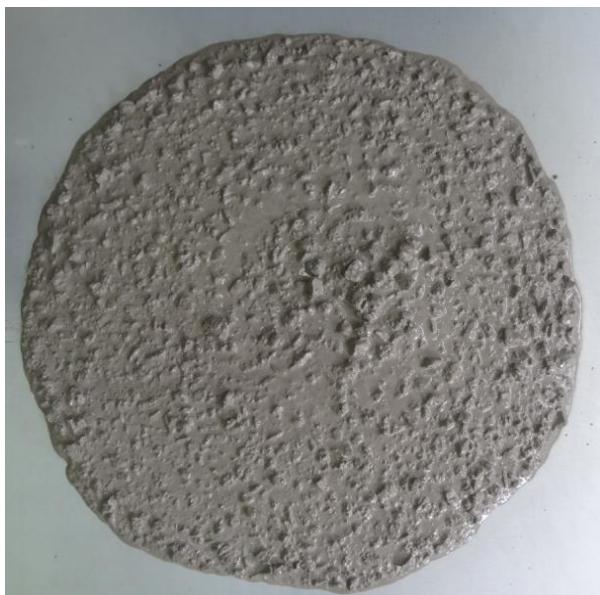
*Slika 6.11.: Rasprostiranje mješavine M9*
