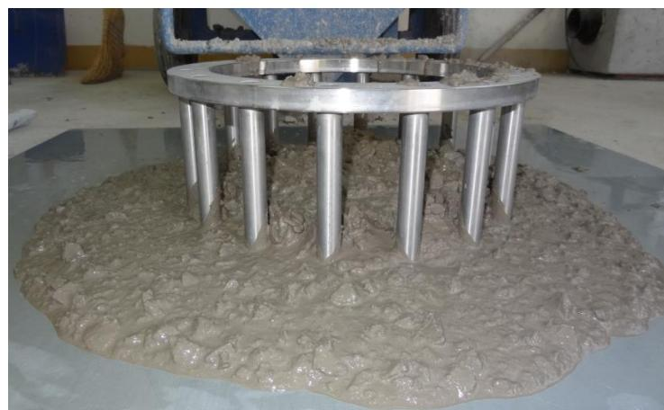
*Slika 6.16.: Ispitivanje J-ring-a (mješavina M7)*
