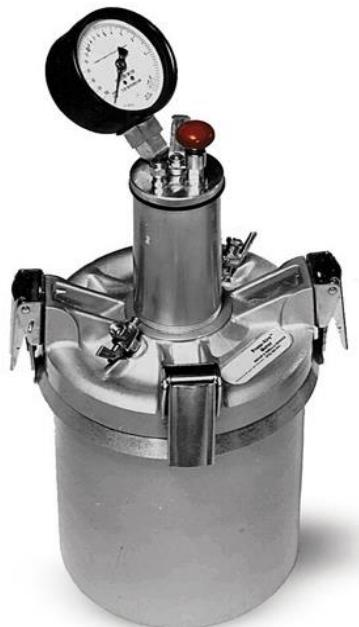
*Slika 4.5.: Uredaj za ispitivanje sadržaja pora u svježem betonu [18]*
