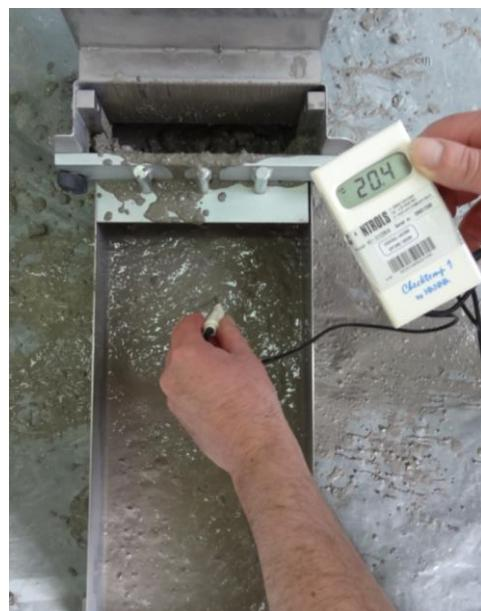
Slika 6.22.: Mjerenje temperature svježe mješavine (M8)
