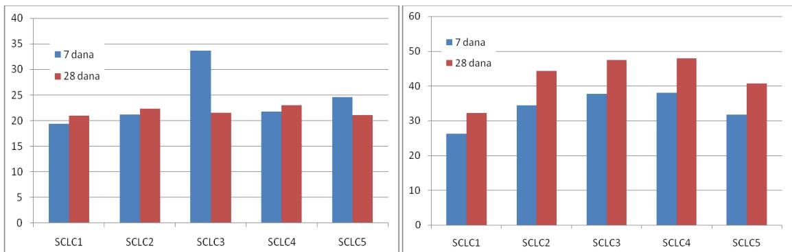
*Slika 5.1.: Dinamički modul elastičnosti (slika lijevo) i tlačne čvrstoće (slika desno) uzorka različitih starosti[22]*
