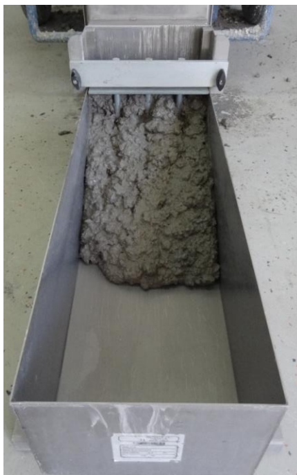
Slika 6.19.: Ispitivanje L – kutijom (mješavina M1)
