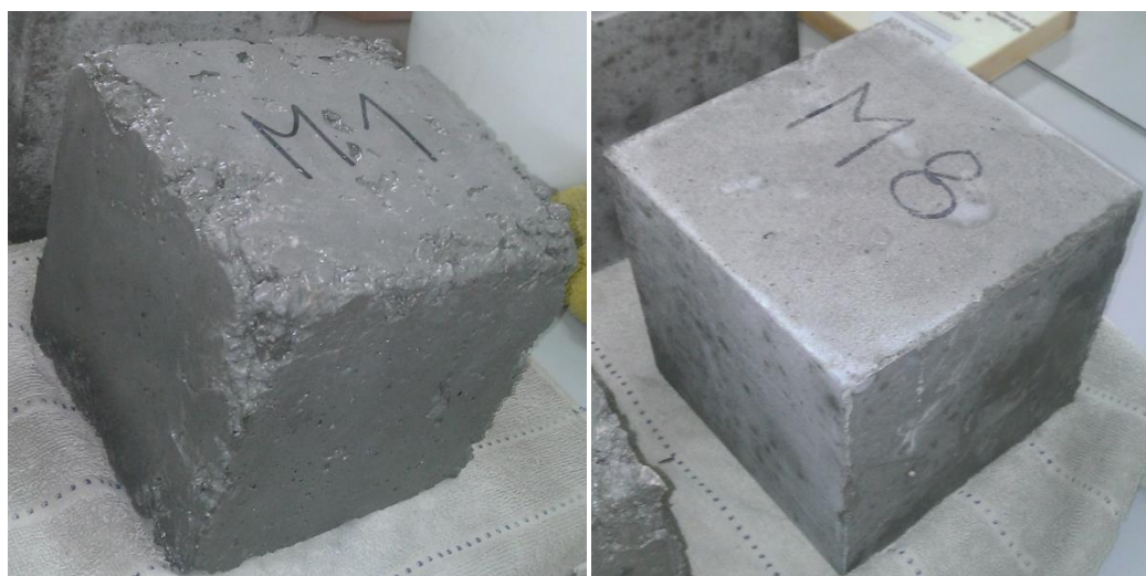
Slika 6.24.: Usporedba vizualnog izgleda uzoraka kocaka M1 i M8
