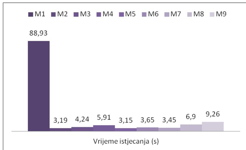
Slika 6.7.: Vrijeme istjecanja uzorka kroz V – lijevak
