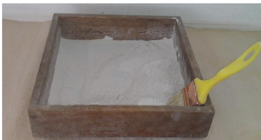
Slika 6.5.: Prosijavanje „bijelog šuta“ na situ  $0,04\text{mm}$
