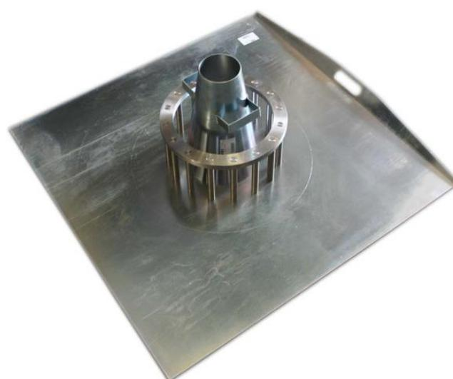
*Slika 4.3.: Oprema za ispitivanje J- prstenom[17]*
