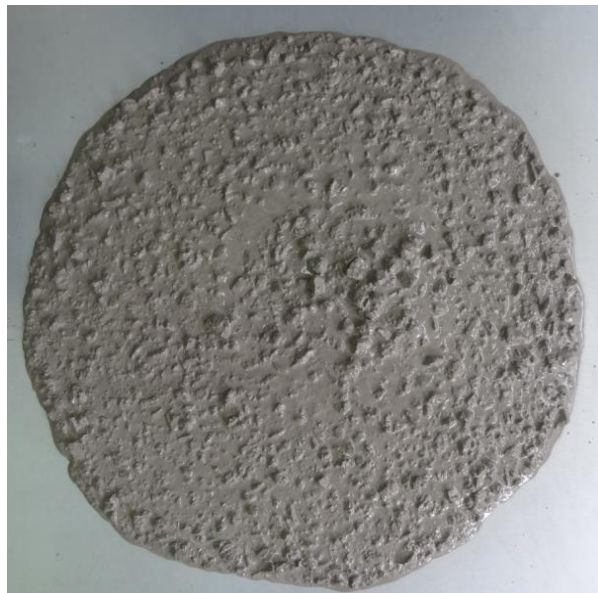
Slika 6.11.: Rasprostiranje mješavine M9
