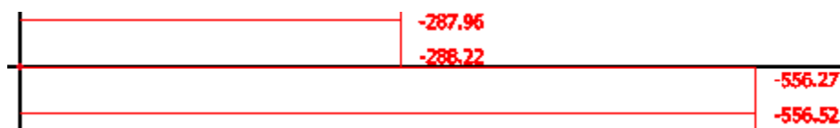
Slika 7.28 Dijagram uzdužnih sila stupa na spoju s gredom na etaži 15 (kN)
