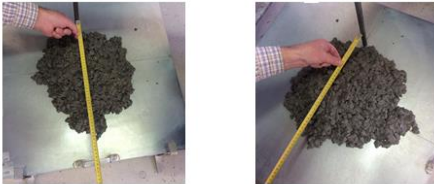
Slika 17. Rasprostiranje betona s dodatkom silikatne prašine [slike zabilježene tijekom ispitivanja]
