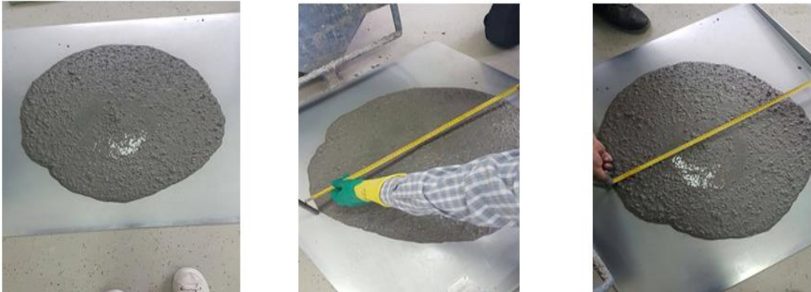
Slika 16. Rasprostiranje betona s dodatkom metakaolina [slike zabilježene tijekom ispitivanja]
