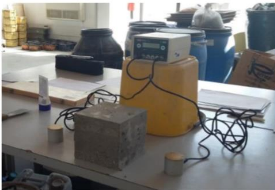
Slika 27. Ispitivanje ultrazvukom [slika zabilježena tijekom ispitivanja]
