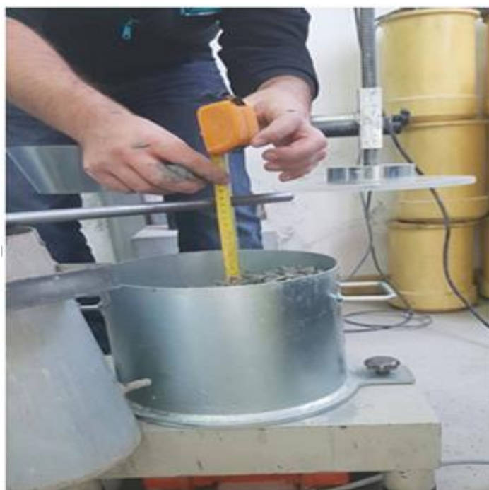
Slika 21. Mjerenje konzistencije Vebe metodom
