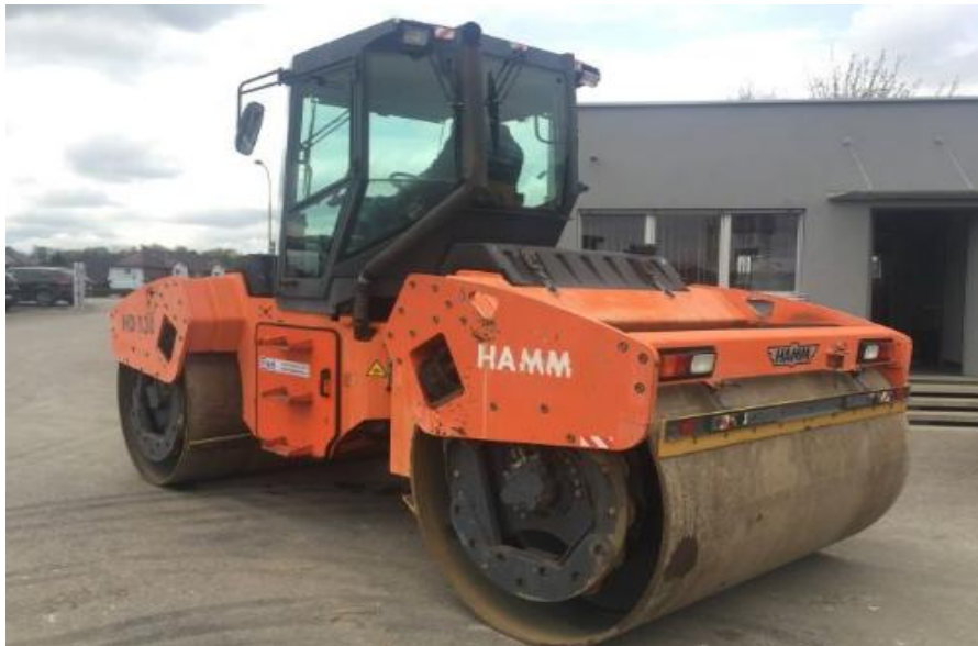
Slika 11- valjak Hamm HD 130 [10]
