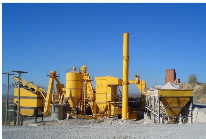
**Slika 12**-Postrojenje za proizvodnju asfalta
