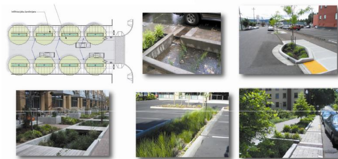
Slika 15.2.3. Mogućnosti odvodnje ulica i parkinga
