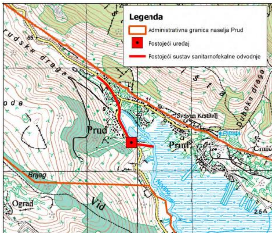
Slika 12.1.2. Prikaz postojećeg sustava odvodnje sanitarno fekalnih voda
