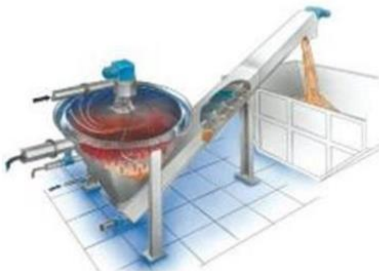
Slika 11.1.2.1. Uređaj za ispiranje pijeska
