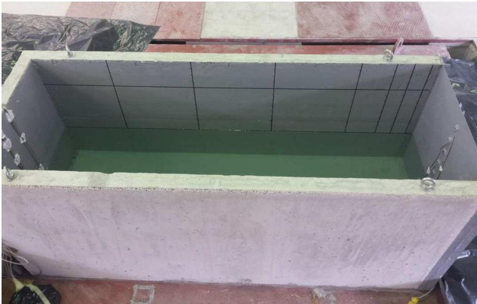
**Slika 5.2.** Fotografija rezervoara R2 spremnog za ispitivanje
