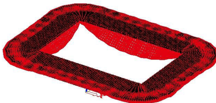
Slika 4.1.1 Deformirani oblik konstrukcije
